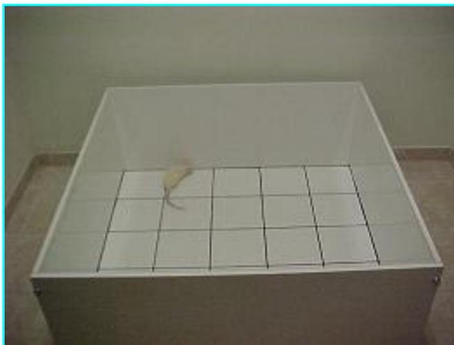
**Figura 3** - O aparato comportamental do campo aberto que foi utilizado nos experimentos.
