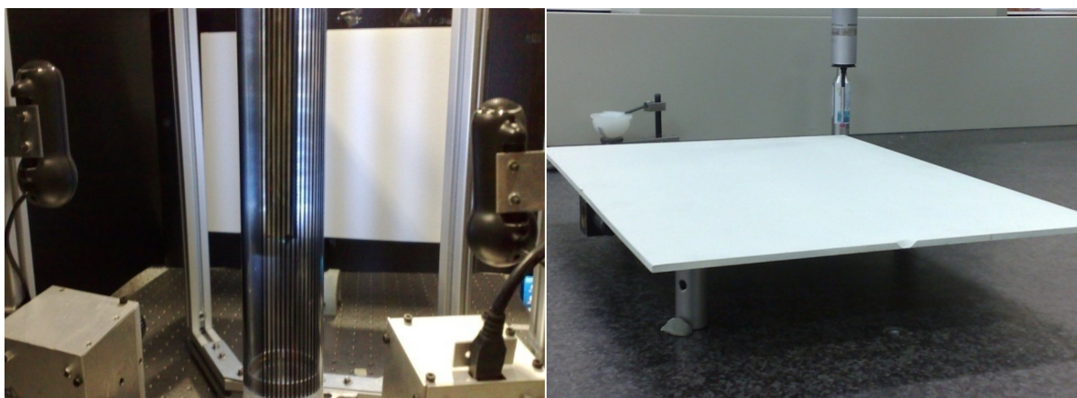
Figura 40 Medição do padrão de referência plano no protótipo e na máquina de medir por coordenadas.
