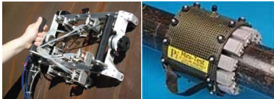
Figura 2 (a) À esquerda, inspeção com transdutor TOFD [36] (b) À direita, sistema de inspeção de dutos baseado em LRUT [36].
