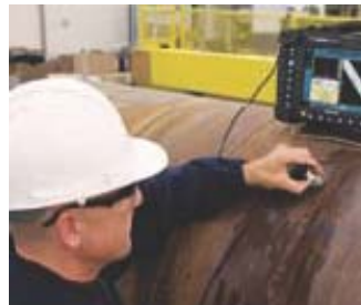
Figura 1 Inspeção de duto com transdutor "phased array" [36].
