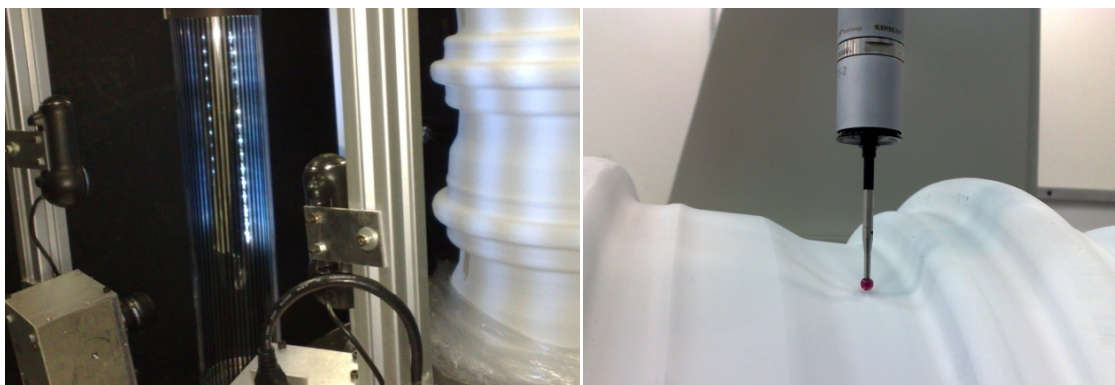
Figura 43 Medição do padrão de referência anelado nos dois sistemas de medição: (a) à esquerda no protótipo, e (b) à direita na máquina de medir por coordenadas.
