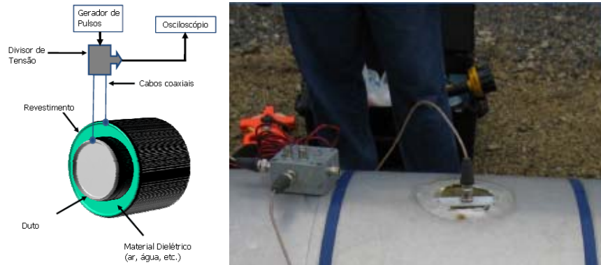
Figura 6 (a) À esquerda, esquema do sistema de medição (b) À direita, o sistema realizando uma inspeção [40].
