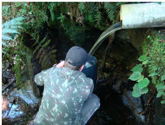
Figura 2.11 Estrutura de medição de vazão e esquema de medição volumétrica
