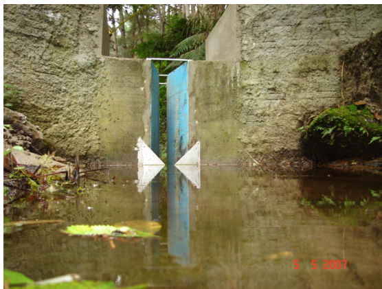
Figura 2.11 Estrutura de medição de vazão e esquema de medição volumétrica
