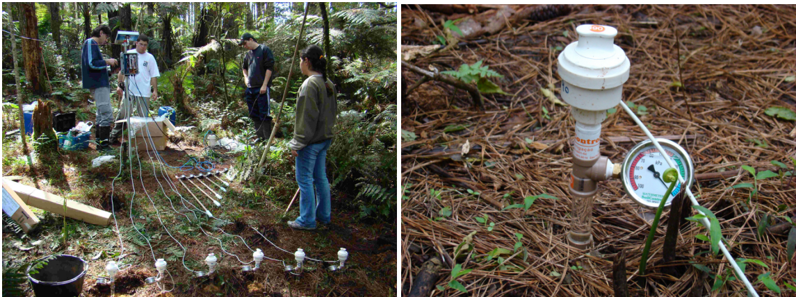
Figura 2.16 Fotos da instalação dos tensiômetros e detalhe da modificação para leitura automática
