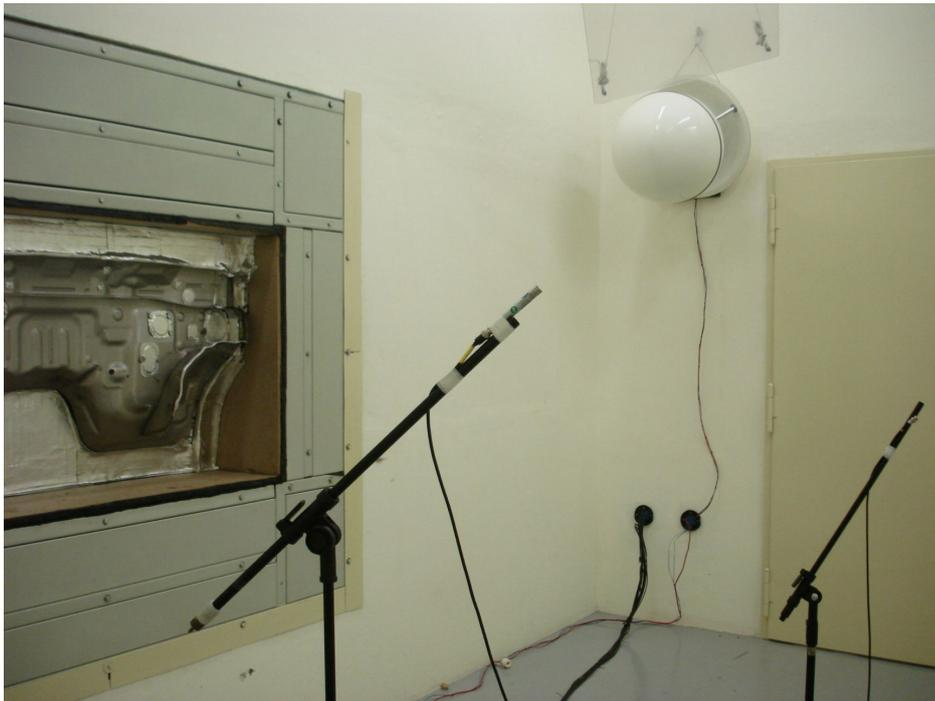
Figura 6.2: Câmara reverberante mostrando em detalhe uma das fontes sonoras, o microfone de referência e a amostra em teste instalada na janela acústica.
