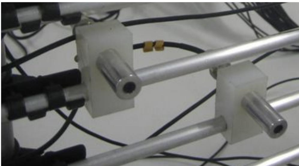
Figura 4.13: Detalhes do suporte dos microfones montados nos tubos de alumínio.
