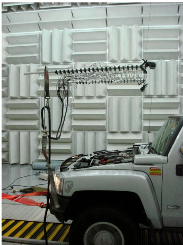
Figura 6.9: Configuração experimental usada durante as medições no dinamômetro de veículos instalado na câmara semi-aneecóica.
