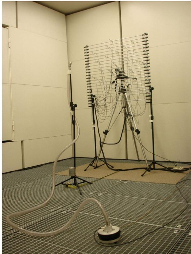
Figura 5.9: Configuração experimental para medição da resposta do arranjo a uma fonte de referência usada como monopólo.
