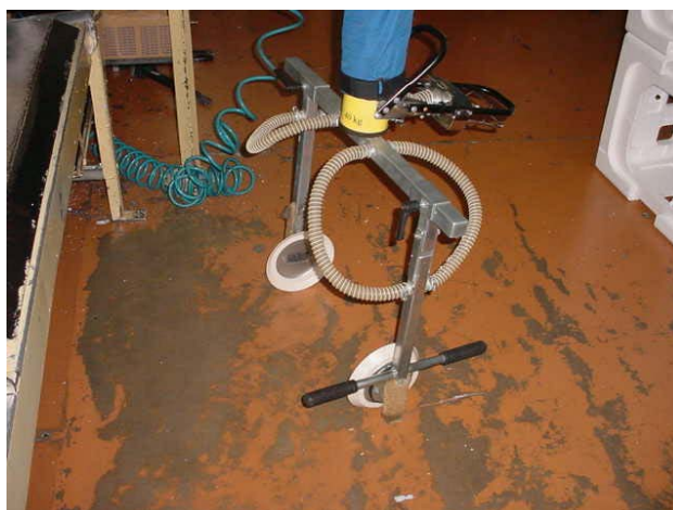
Figura 5.19 - Vista equipamento, ventosa, sugestão para uso na linha de produção
