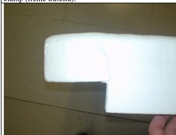
E - Vista do amassamento do tampo superior em EPS decorrente de teste de clamp (frente traseira).
