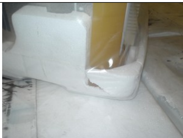
B - Trinca da base em EPS ocorrido durante o teste de queda livre.
