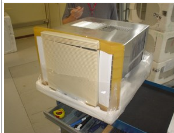
C - Quebra do painel ocorrido durante o teste de clamp (frente traseira).
