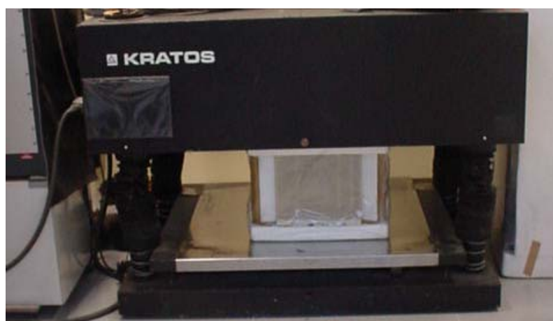
Figura 5.18 – UE durante o teste e compressão
