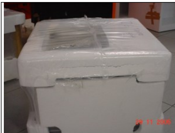
A - Trinca da região traseira do tampo ocorrido no teste de clamp (frente traseira).
