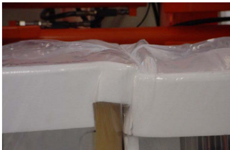
Figura 5.14 – Outra vista em detalhe deformação excessiva na região do tampo próximo ao painel
