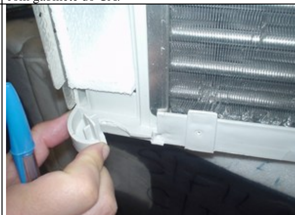
J - Quebra do canto da base do CA, ocorrido no teste de queda livre.
