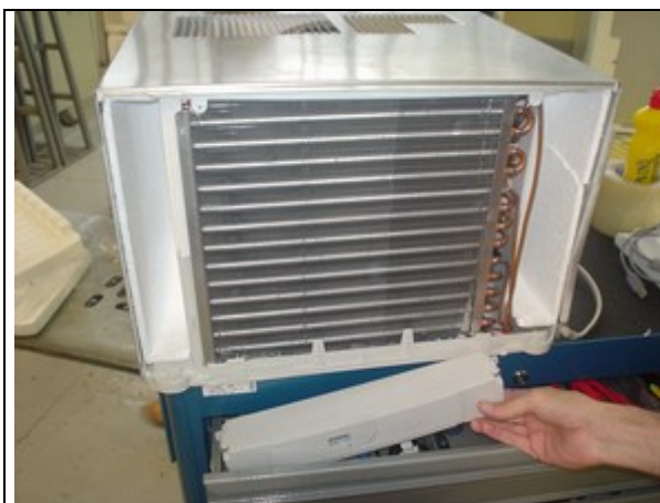
G - Vista frontal do CA sem painel. Queda da caixa do controle por má fixação e trinca da evoluta direita.
