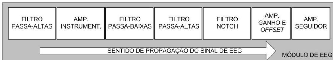
Figura III.2. Cadeia de condicionamento de sinais de EEG.
