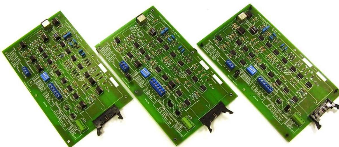
**Figura III.3.** Módulo de ECG, EOG e EMG, implementados com o mesmo *layout*.
