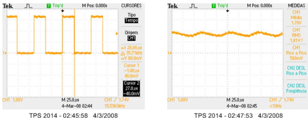
Figura 4.5. Saída PWM (esquerda) e nível RSSI mínimo (direita) para transmissão confiável.
