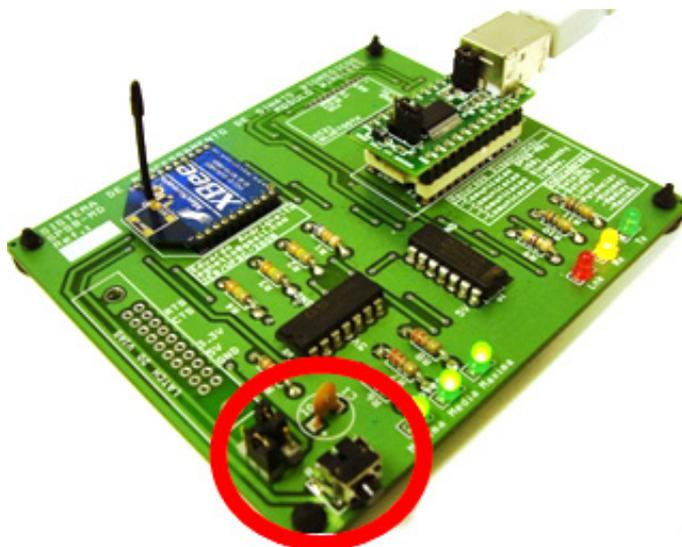
**Figura 69** – Identificação do chave *reset* nos módulos *wireless*.
