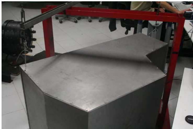
Figura 4.4: Medições no carro modelo, fechado e pendurado em garagem do LVA, para TPA Estrutural.
