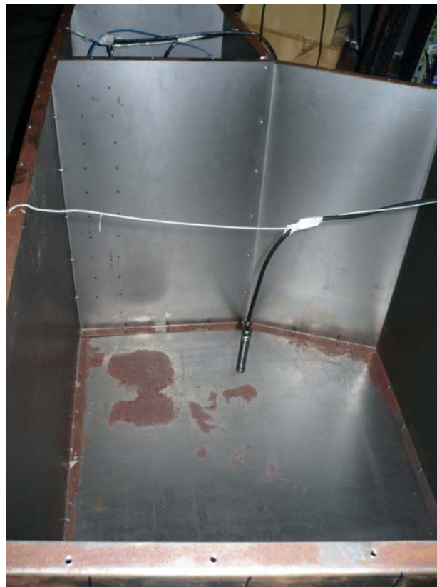
Figura 4.8: Configuração ponto de resposta (microfone) em cavidade de passageiros, para TPA Aéreo.
