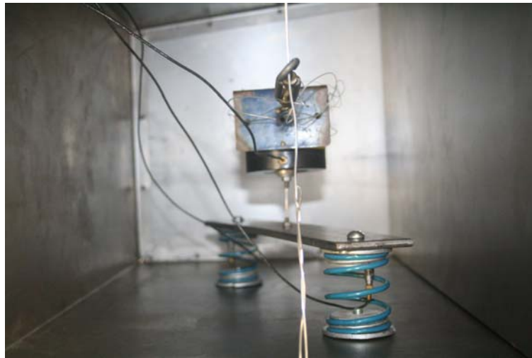
Figura 4.5: Configuração da excitação criada dentro da cavidade do motor do carro modelo
