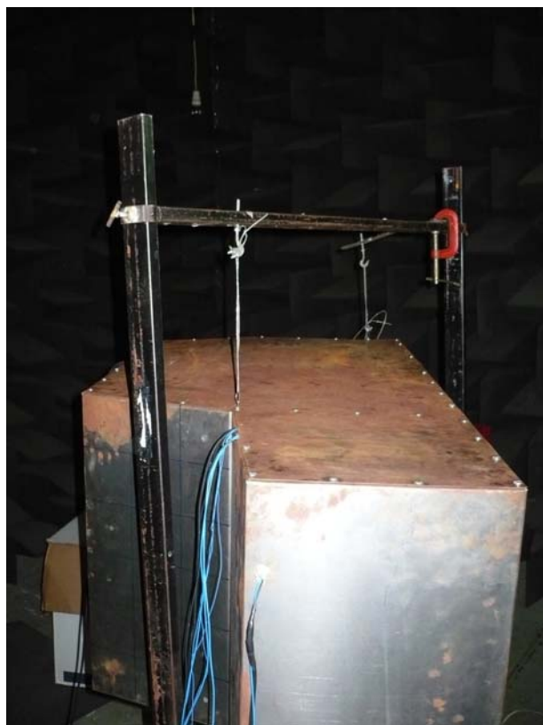
Figura 4.7: Medições no carro modelo, fechado e pendurado em sala semi-anecoica, para TPA Aéreo.
