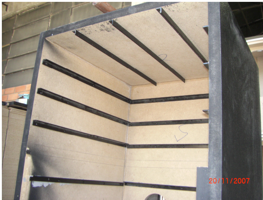
Figura 7.10 – Fixação das barras metálicas no interior da caixa.
