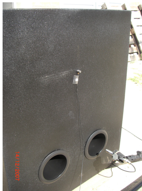
Figura 7.16 – Caixa finalizada com o acabamento nos dutos.
