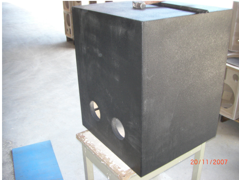
Figura 7.15 – Posicionamento dos dutos na câmara ventilada.
