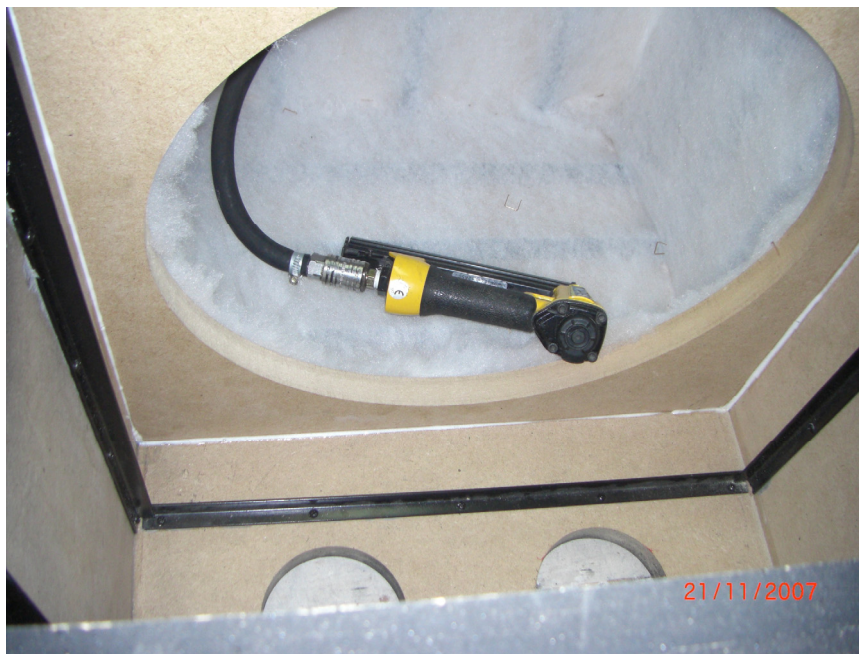
Figura 7.25 – Caixa construída com MDF 25 mm de espessura e travas internas de aço.
