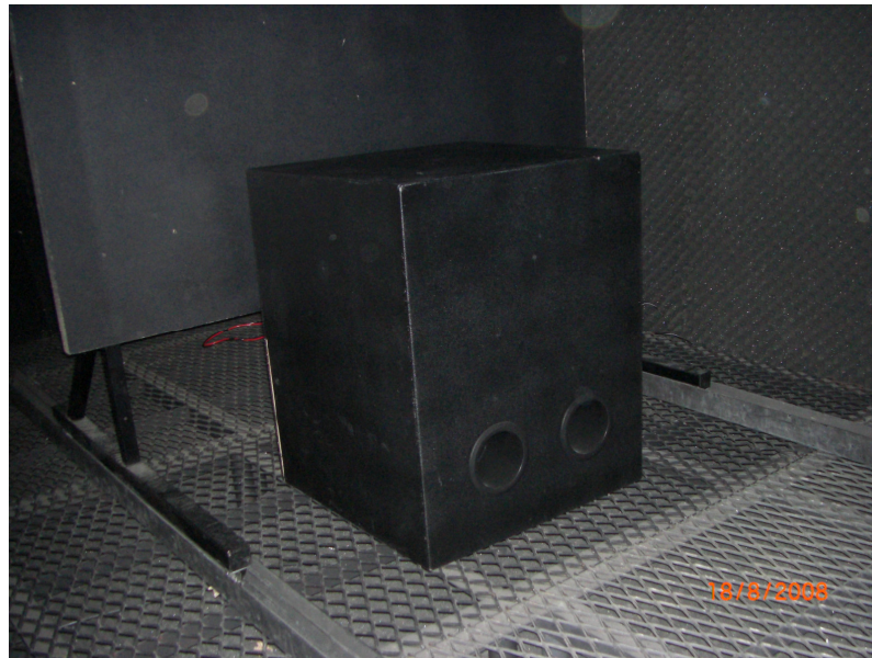
Figura 7.23 – Foto da caixa Bandpass na câmara anecóica da Frahm.
