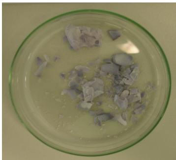
Figura 18 - Material seco obtido da extração da biomassa produzida em biorreator por Chromobacterium violaceum . A coloração violácea é devida à presença de violaceína.
