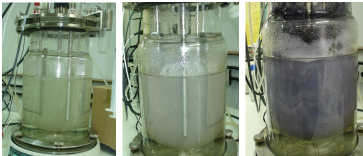
Figura 16 - Produção de poli-hidroxicanoatos em Chromobacterium violaceum utilizando biorreator de bancada. A coloração violácea do meio de cultivo é devido à formação da violaceína.
