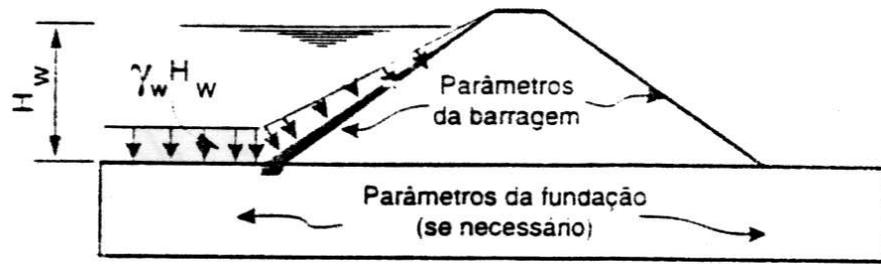
Figura 23: Ações durante o enchimento do reservatório com fundação impermeável (CRUZ (1996) p. 434).
