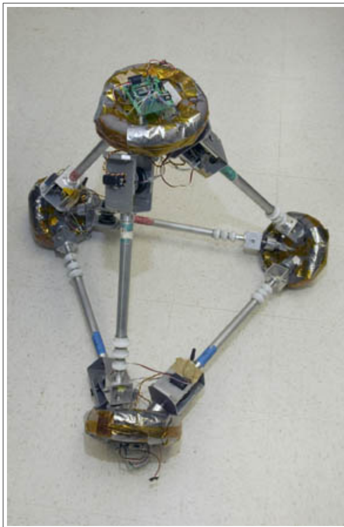
Figura 3.1: TETwalker - Robô de reconhecimento desenvolvido pela NASA Fonte: [NAS 05]
