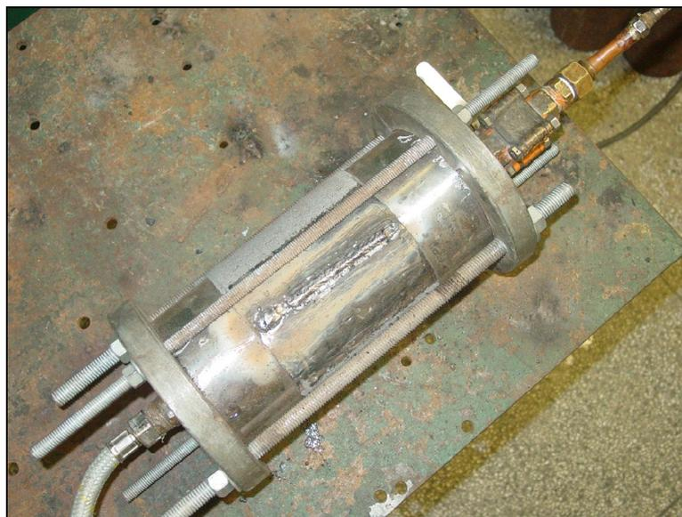
Figura 4.68- Corpo de prova de tubo já montado com flanges e mangueiras pronta para pressurização ou escoamento de água.
