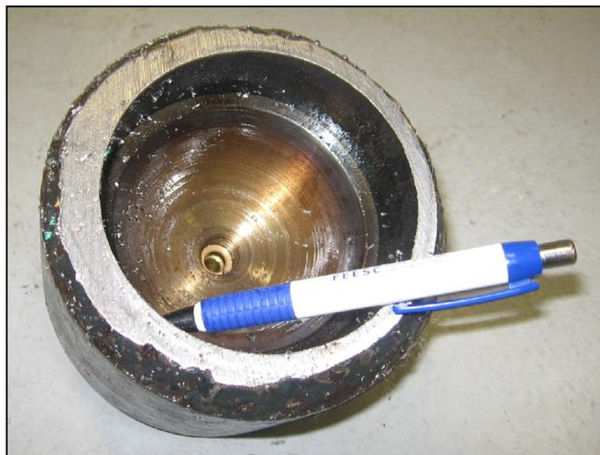
Figura 4.83- Tampão com geometria interna de calota utilizado para fechamento.
