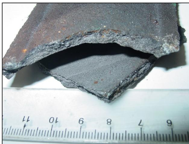
Figura 4.88- Revestimento despreendido do tubo durante a pressurização.
