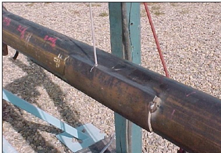
Figura 2.4– Solda de filete entre tubo e calha [2].
