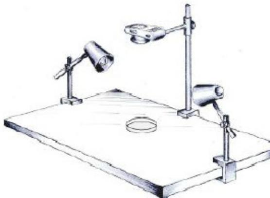
**Figura 4.5** Esquema do sistema utilizado para realizar as fotografias com câmara digital.
