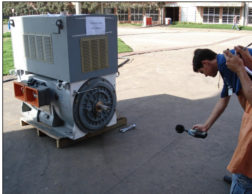
Figura 3.26 – Foto da medição de nível de pressão sonora realizada no motor.
