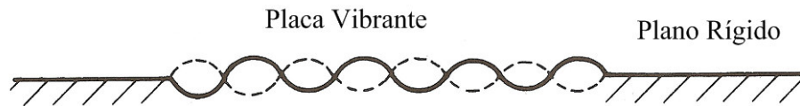
Figura 4.6 – Radiação do ruído de uma placa finita circundada por um plano rígido.
