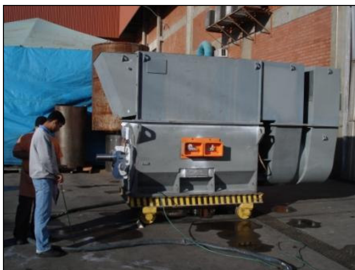
Figura 6.7 – Foto da medição do nível de pressão sonora do motor.
