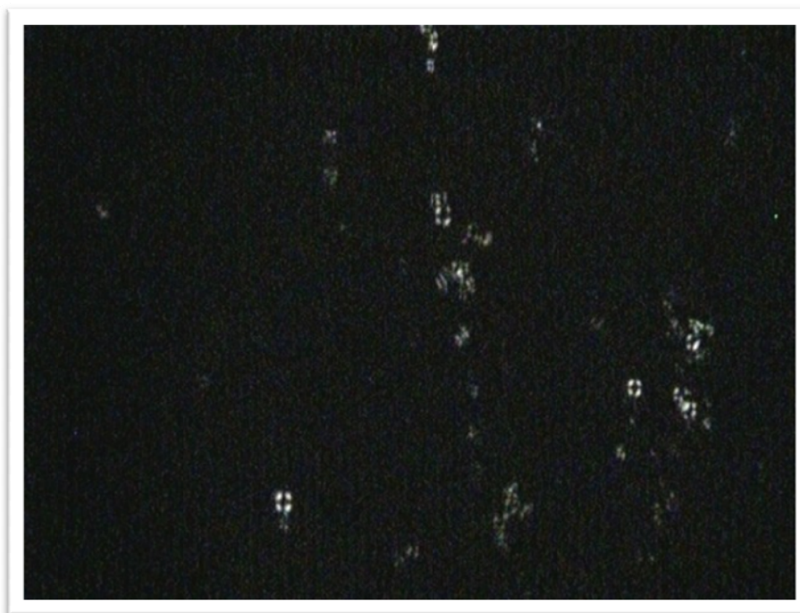
Figura 3.8 – Microscopia de luz polarizada (aumento de 200X) da amostra W_{APFO} = 8,0\% e W_{CsCl} = 3,0\% ; fotografada a uma temperatura de 10^{\circ}\text{C} . A amostra foi preparada colocando-se uma pequena gota da solução entre duas lâminas de vidro com aproximadamente 20\ \mu\text{m} de separação.
