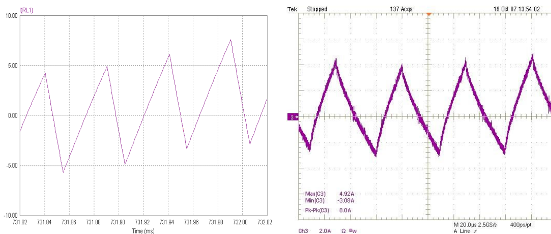
Fig. 6.8 – Detalhe da corrente no indutor de entrada do conversor.
