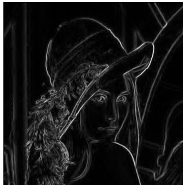
Figura 15 - Operador Sobel aplicado à Figura 6
