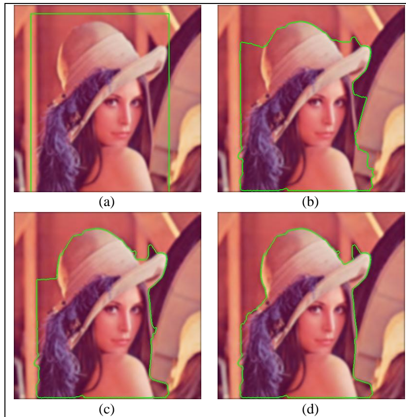
Figura 19 - Aplicação de Contornos Ativos - (a) Imagem processada com contorno inicial na cor verde; em (b), (c) e (d) evolução da curva após 600, 1100 e 1600 iterações, respectivamente.
