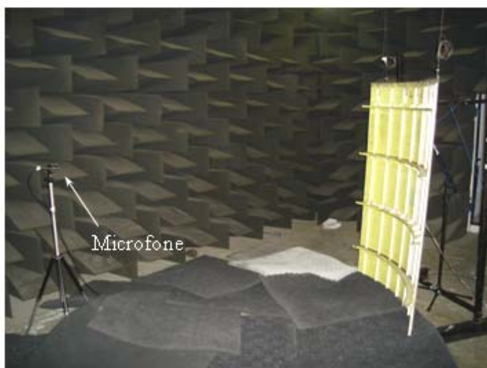
Figura 5.31 – Ensaio para determinar o ruído irradiado pelo painel sem material viscoelástico.
