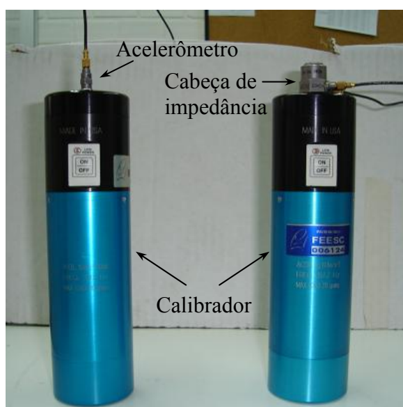
Figura A.1 – Calibração da aceleração do acelerômetro (esquerda) e da cabeça de impedância (direita).
