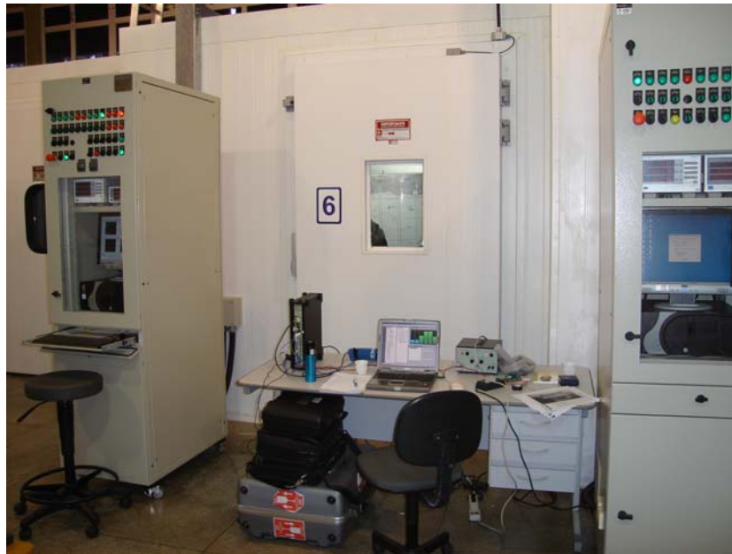
Figura 3.39 – Câmara térmica do POLO-UFSC com controle eletrônico de umidade e temperatura.
