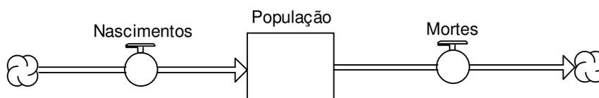
Figura 14 - Representação de um sistema com um estoque e fluxos de entrada e saída.
