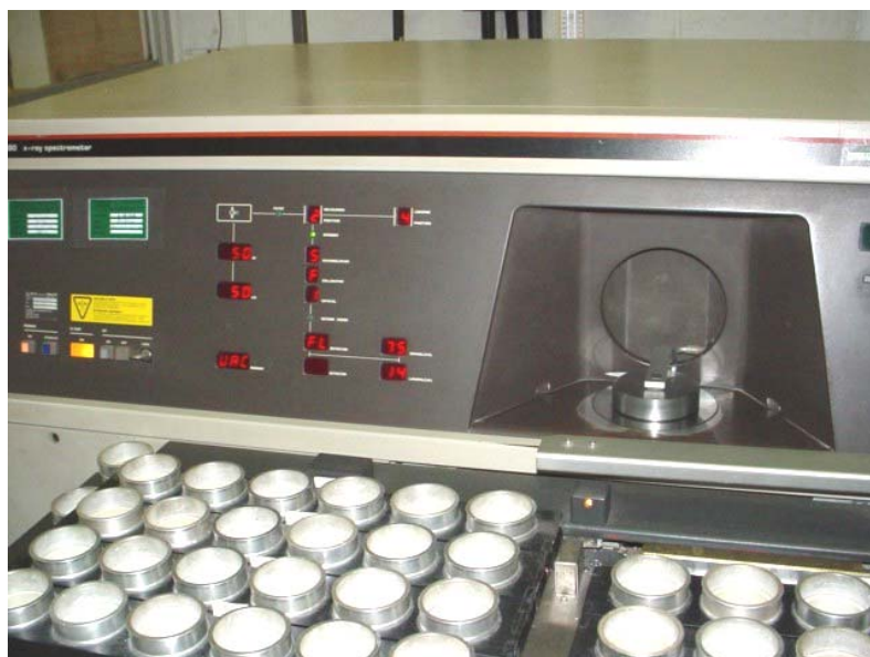
Figura 4.4 - Espectrômetro de fluorescência de raio-x e pastilhas preparadas para análise, do laboratório SGS Geosol
