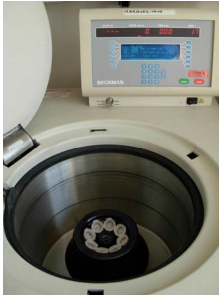
Figura 4.8 - Centrífuga com rotor de 8 tubos usada na separação dos sólidos e sobrenadante nas etapas da extração
