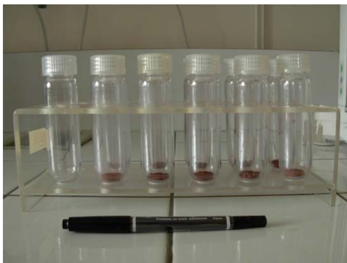
Figura 4.7 - Tubos de centrífuga contendo a massa de solo usada nas etapas da extração sequencial de BCR
