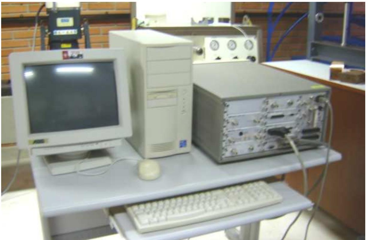
Figura 8.8. Analisador de sinais HP3566/65A.
