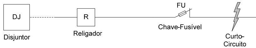
Figura 24. Coordenação entre religador e elo fusível.
