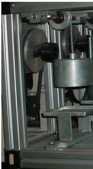
Figura 3.12 - Detalhe da aplicação das cargas radiais nas pontas de eixo nos ensaios de bucha.
