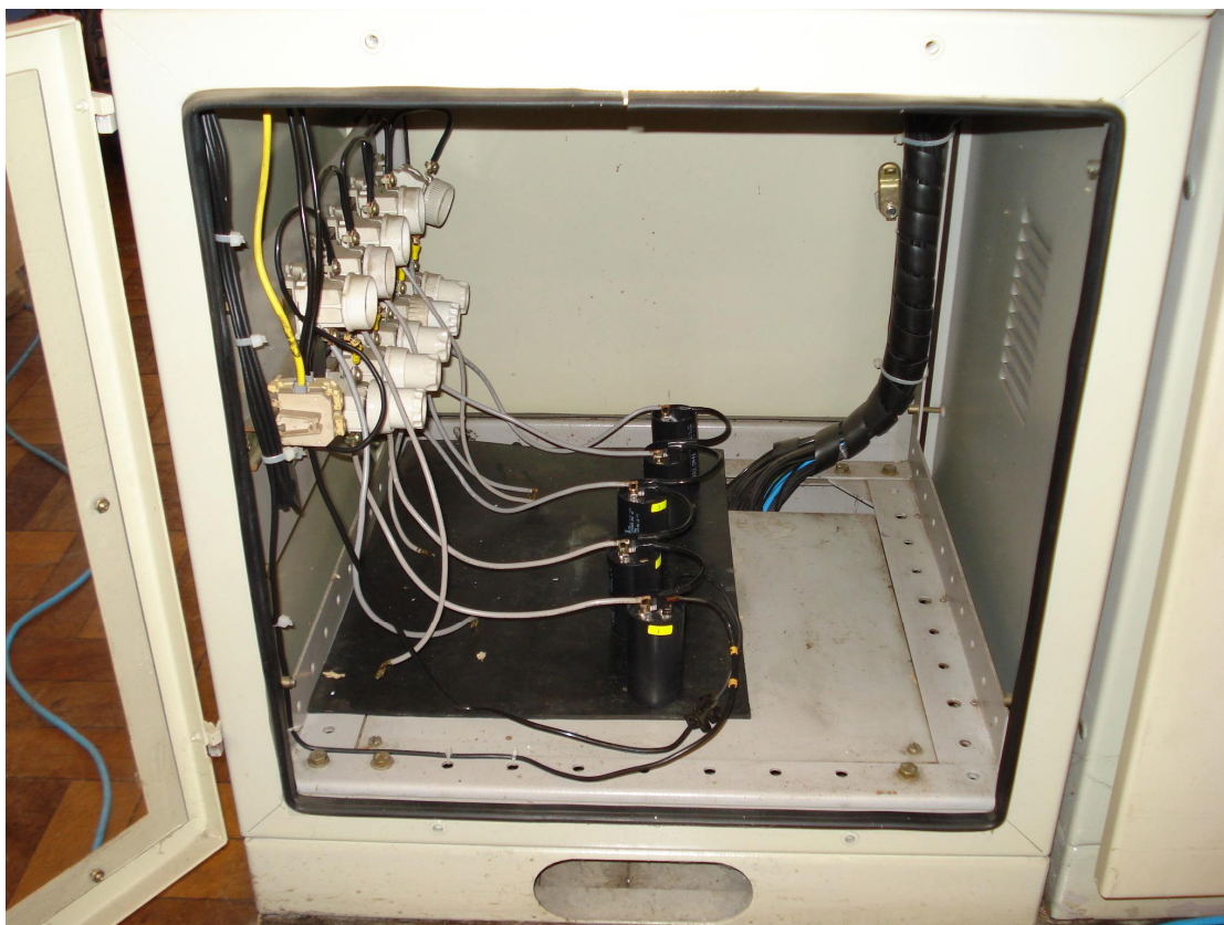
Figura 3.22 - Vista interna da bancada de ensaio de vida em capacitores.
