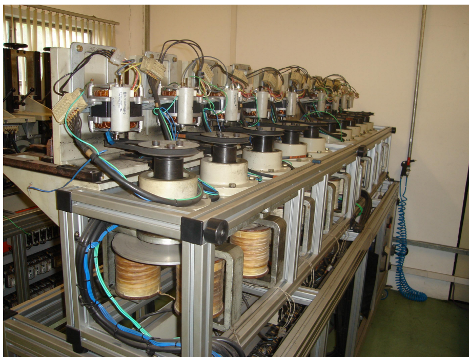
Figura 3.2 - Detalhe da bancada de teste de vida de motores em carga.
