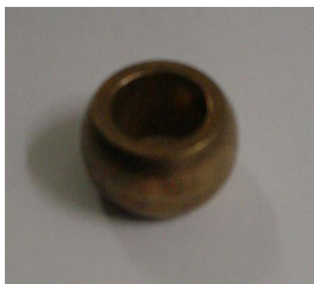
Figura 3.10 - Detalhe da bucha utilizada nos motores ensaiados.
