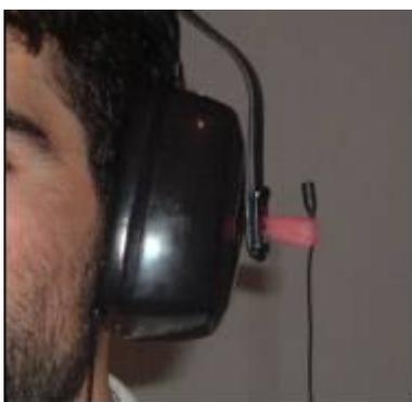
**Figura 3.6. Suporte de Silicone Usado para a Localização do Mic DPA Fora da Concha do Protetor.**
