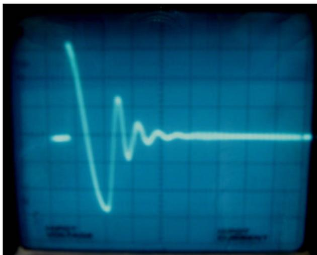
Figura 5.13 – Formas de onda de tensão em duas fases dos estatores 1, 2 e 3 (tensão ajustada em 5000V).
