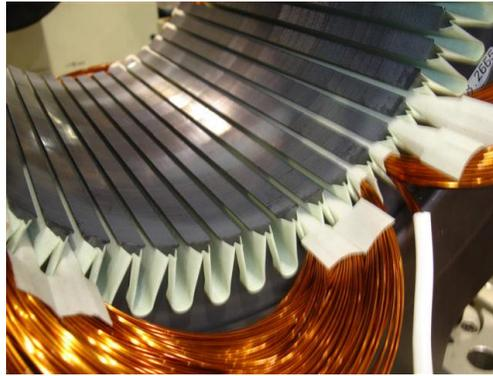
Figura 2.8 – Isolante entre camadas.
