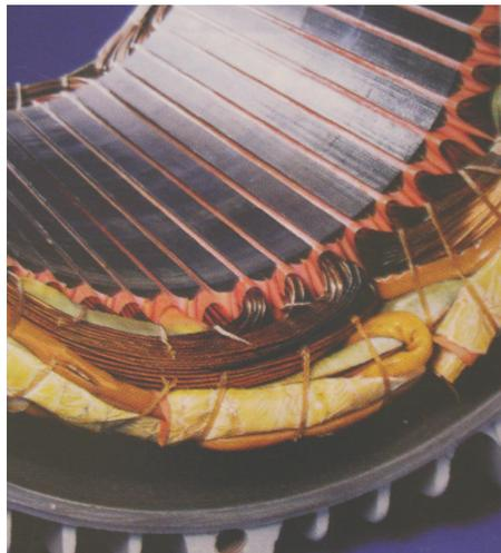
Figura 2.1 – Curto-circuito entre espiras na cabeça de bobina.
