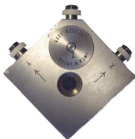
**Figura 4** – Acelerômetro Triaxial do tipo 4321, da Brüel & Kjaer.
