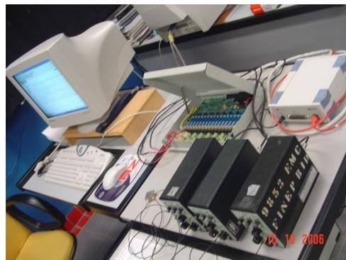
**Figura 6** – Módulo Condicionador de Sinais, conversor AD e computador
