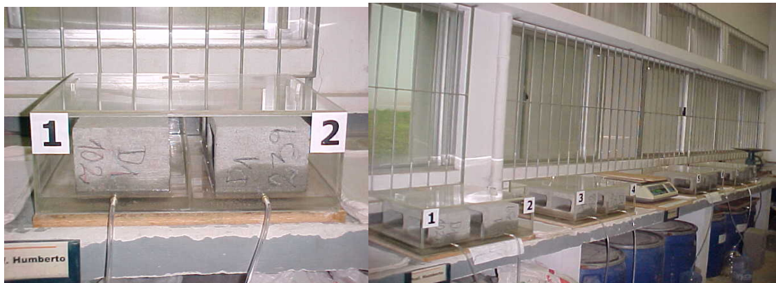
Foto 3.2 - Esquema utilizado para a realização do ensaio de IRA e absorção de água ao longo do tempo.
