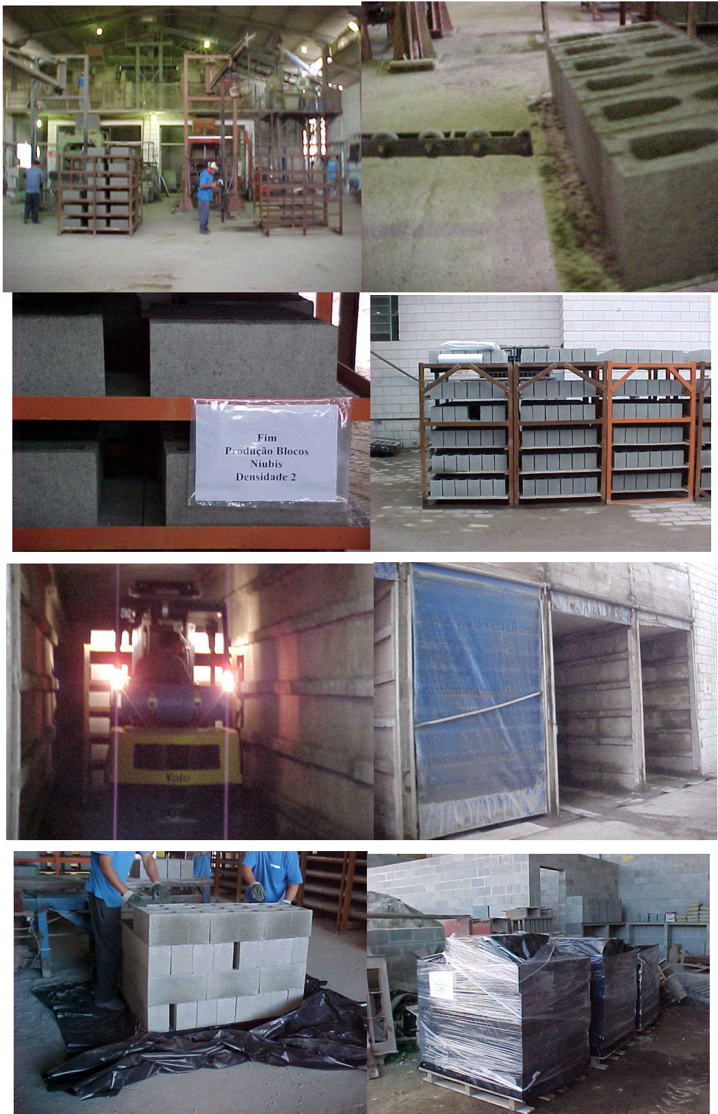
Foto 3.1 - Processo fabricação dos blocos de concretos produzidos na Toniolo
