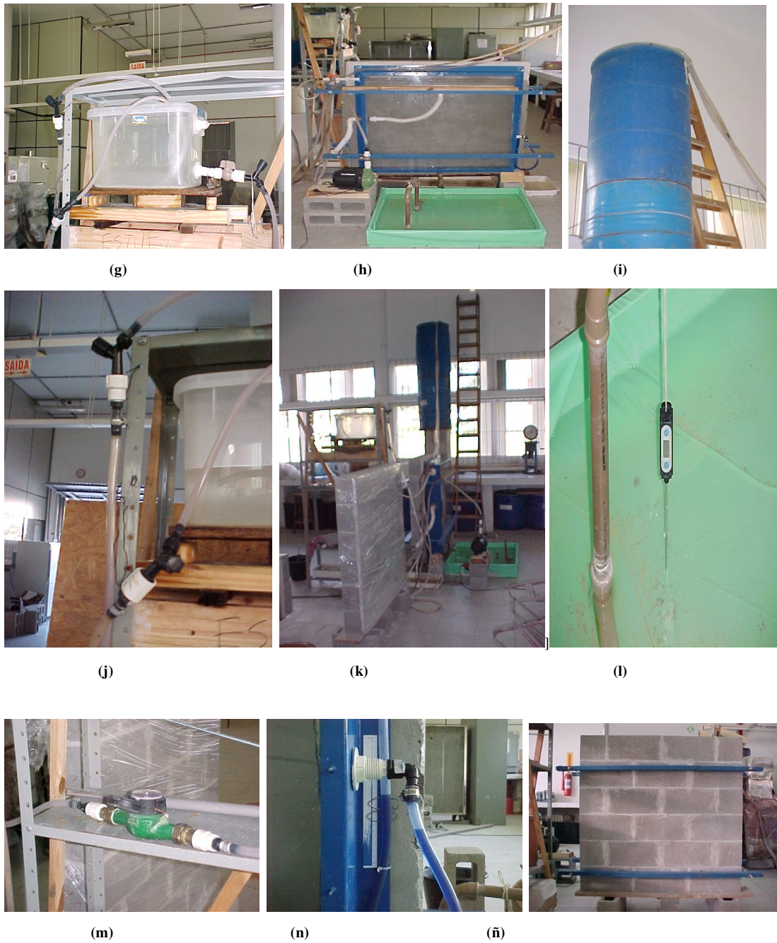
Foto 3.8 - Processo de realização de ensaio de estanqueidade
