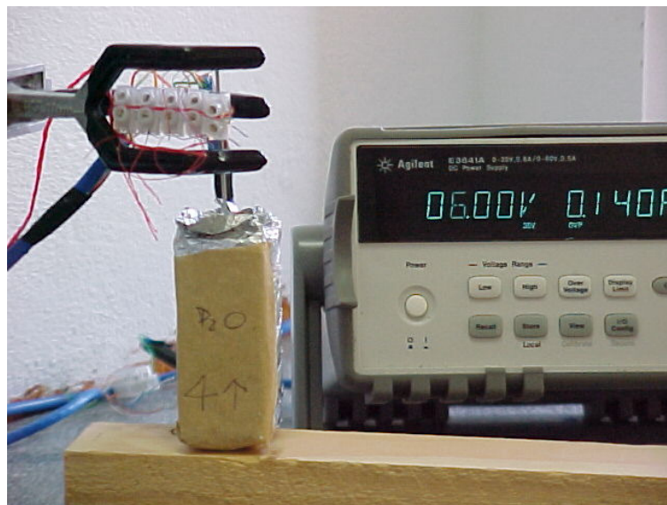
Foto 3.7 - Sonda utilizada para a determinação da condutividade térmica
