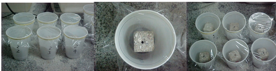
Foto 3.6 - Procedimento utilizado para umedecer as amostras para a calibração da sonda
