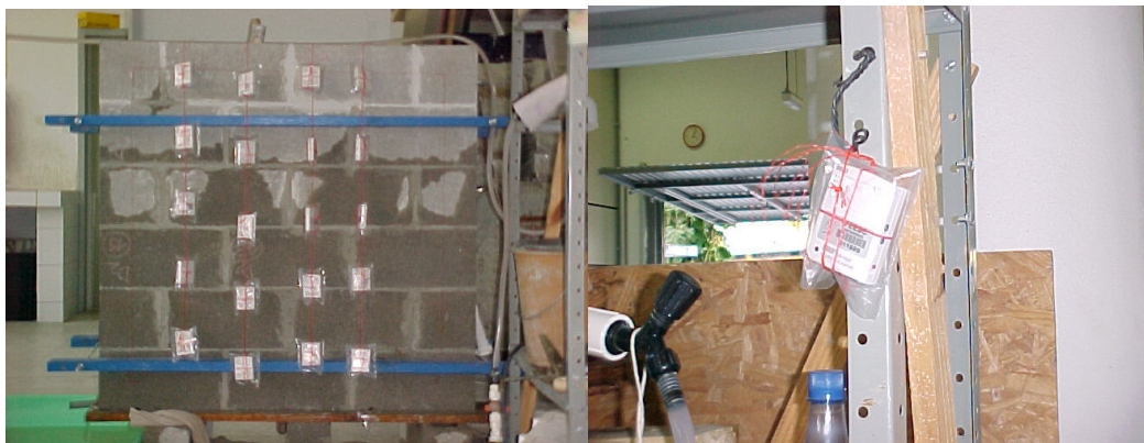
Foto 3.9 - Monitoramento de HR e Temperatura no interior através de Hobbos
