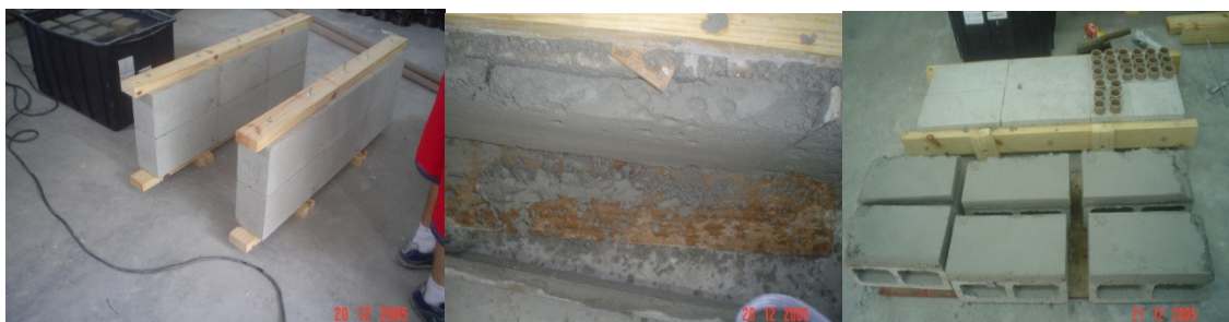
Foto 3.3 - Esquema geral de processo de realização dos painéis para extração amostra.
