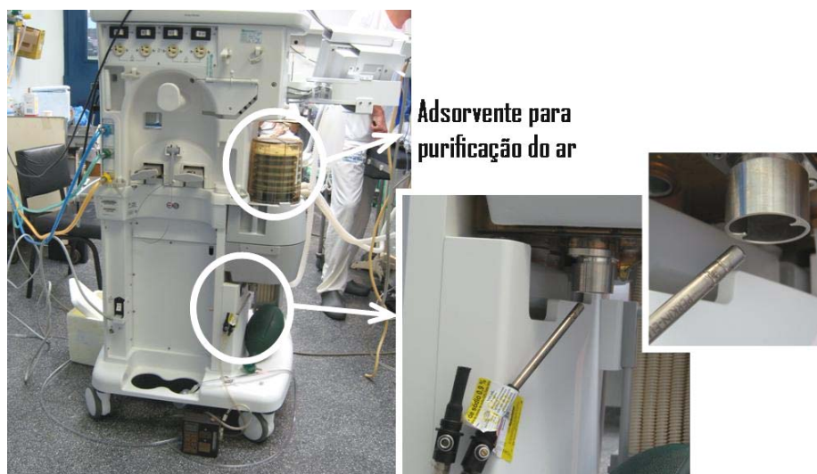
Figura 22: Retirada da amostra nº5 de COV da sala de cirurgia nº1
