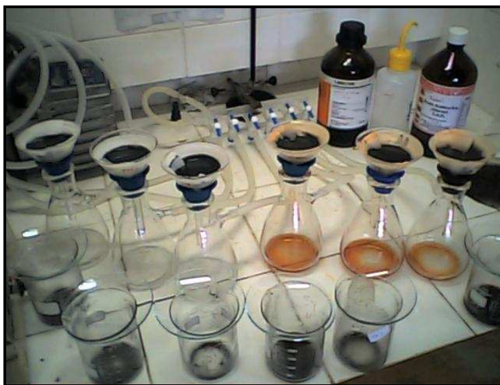
Figura 9.1 – Etapa de filtração para determinação do resíduo solúvel com ácidos acético e nítrico.
