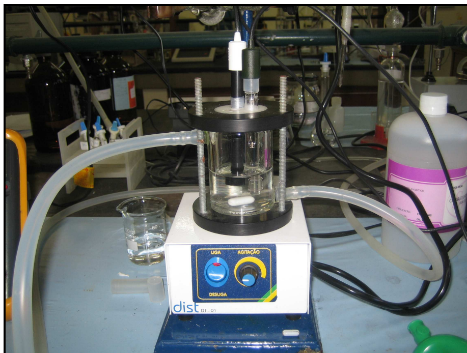
Figura B.1 – Equipamento utilizado na titulação potenciométrica.
