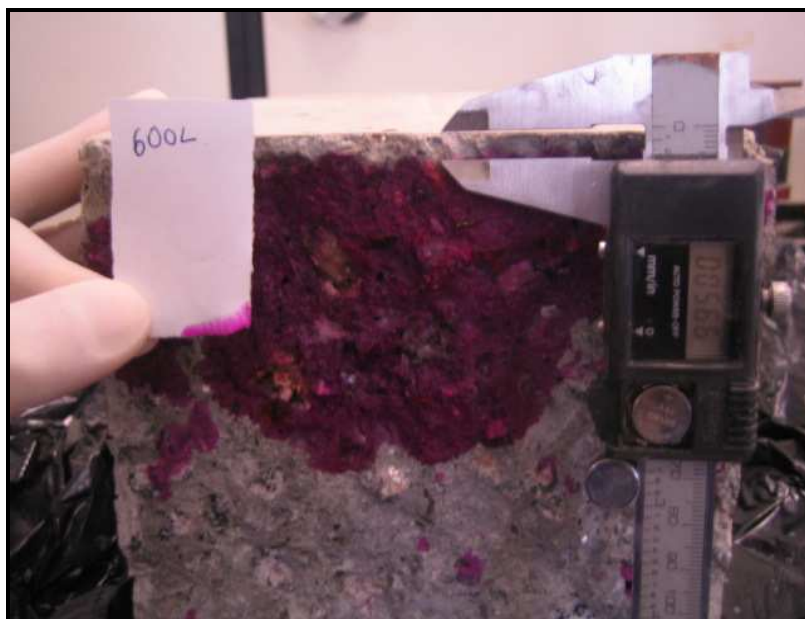
Figura C.2 – Frente de carbonatação no bloco a 600 metros do mar livre de obstáculos após 12 meses de exposição.
