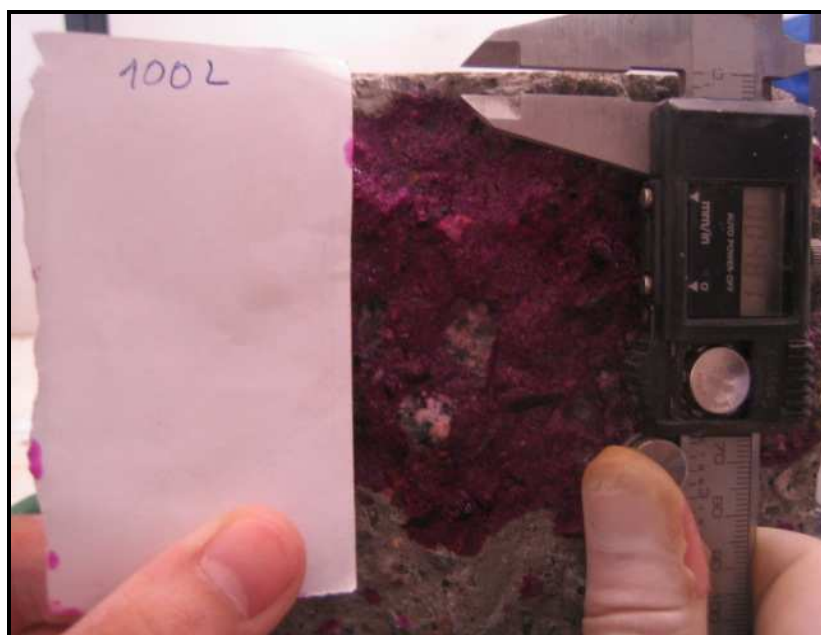
Figura C.1 – Frente de carbonatação no bloco a 100 metros do mar livre de obstáculos após 12 meses de exposição.
