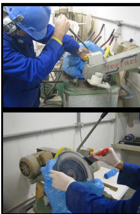
Figura 6.7 – Extração e coleta das amostras em pó.
