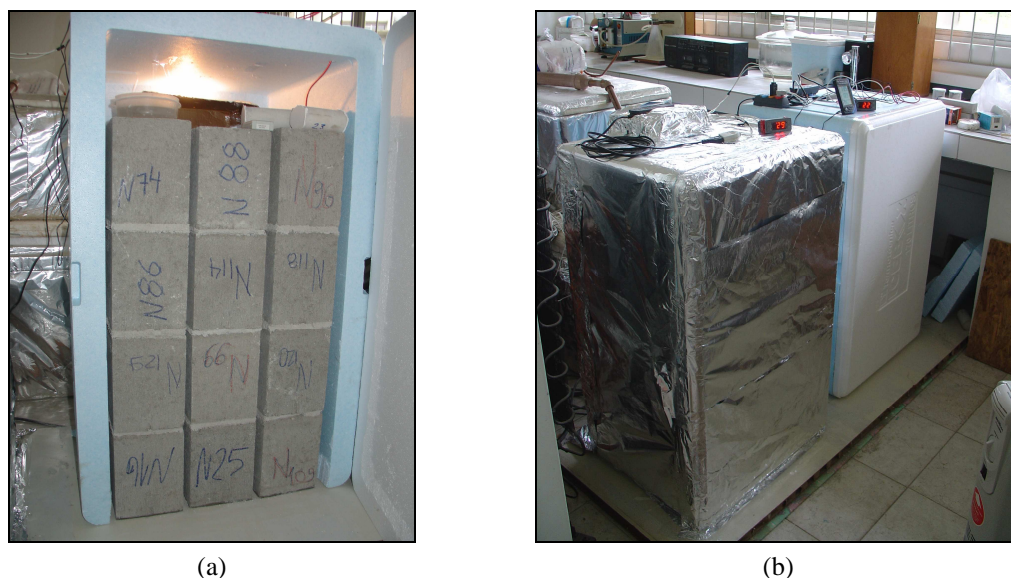
Figura 94. (a) Interior da caixa e (b) vista geral das duas caixas utilizadas para controlar a temperatura de cura.
