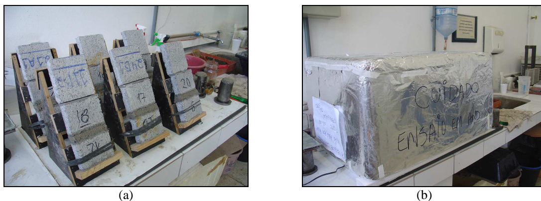
Figura 106. (a) mini-prismas já moldados e (b) caixa utilizada para manter a temperatura de (30 \pm 1)^\circ\text{C} após o término da moldagem.
