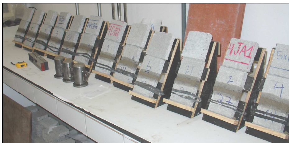
Figura 83. Aparato utilizado para a moldagem dos mini-prismas.
