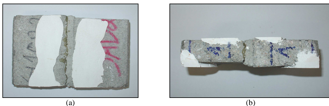
Figura 107. União da junta com a amostra do bloco de concreto após a primeira ruptura (a) vista superior e (b) vista lateral.
