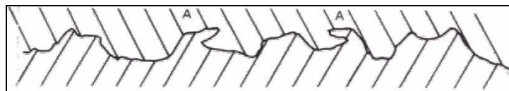
Figura 6. Diagrama esquemático do intertravamento mecânico entre adesivo e substrato (HULL & CLYNE, 1996 apud GONÇALVES, 2004).
