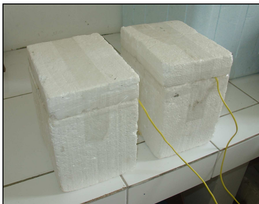
Figura 100. Calorímetro utilizado para a determinação do tempo de pega das argamassas de assentamento.
