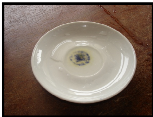
Ilustração 72. Presença de nitrato (coloração verde azulada) Fonte: Autora (2007)
