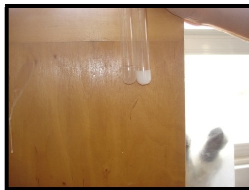
Ilustração 73. Presença de precipitação de sais Fonte: Autora (2007)
