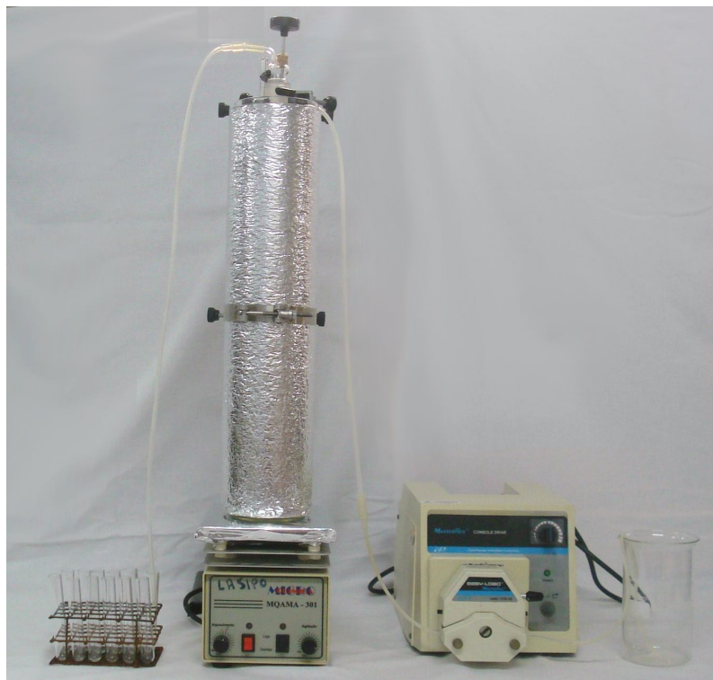
Figura 3.3 – Sistema utilizado para extração de inulina do alho a 60°C.
