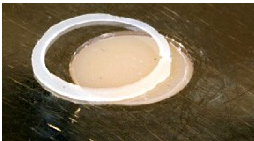
Figura 25 - Excesso de resina fraturado
