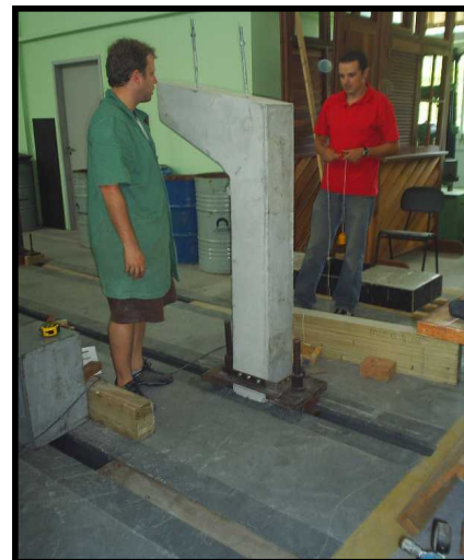
Figura 4.31 - Pilar encaixado na laje de reação
