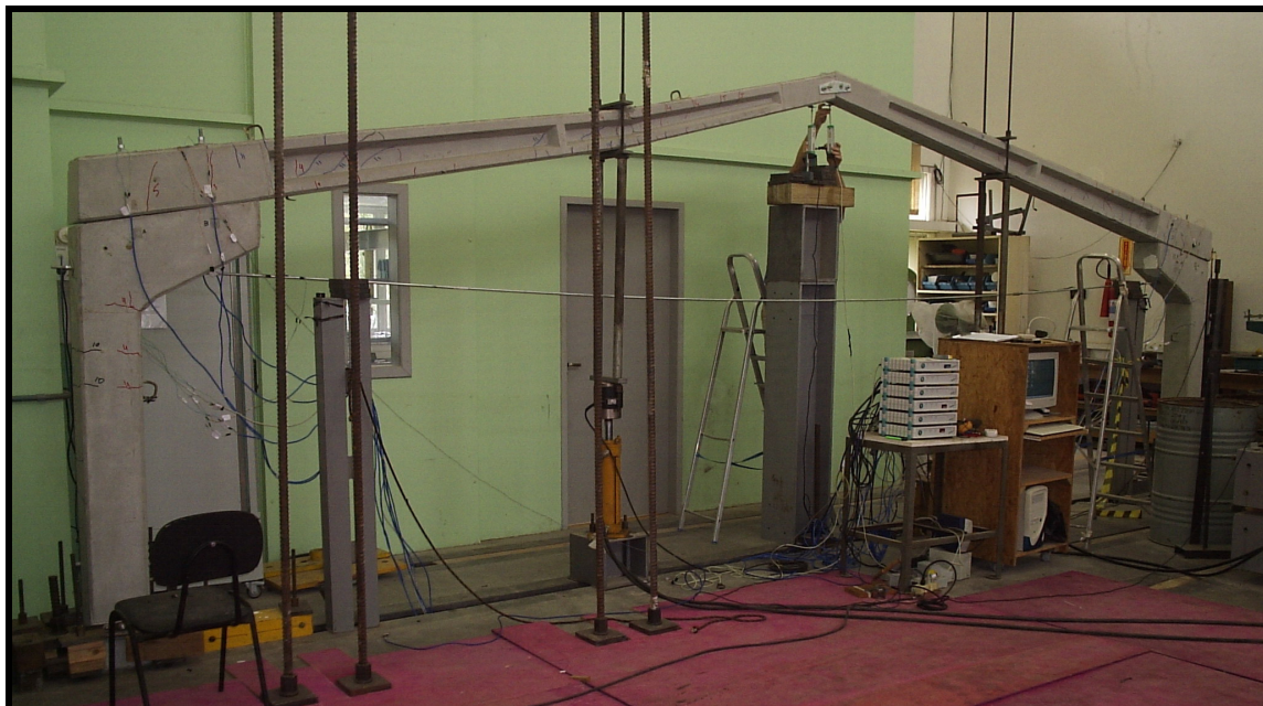
Figura 6.10 – Vista diagonal do pórtico deformado após as rupturas localizadas
