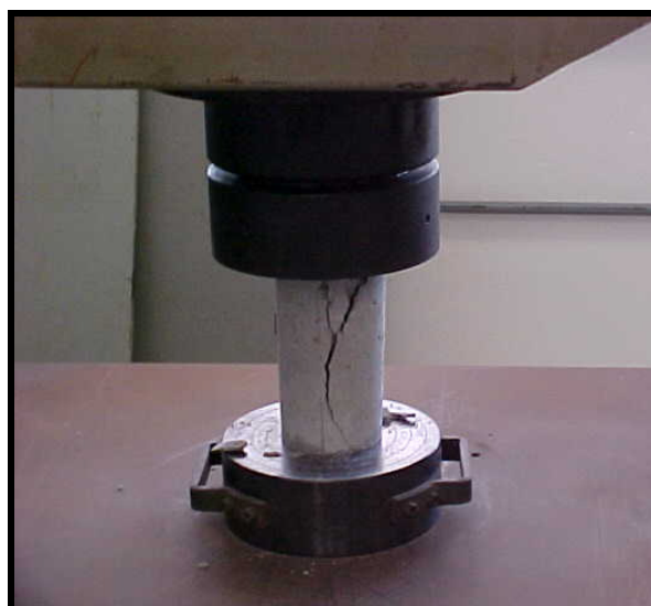
Figura 4.3 – Corpo-de-prova em ensaio de resistência a compressão simples
