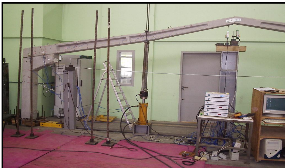
Figura 6.11 – Vista Frontal do pórtico deformado
