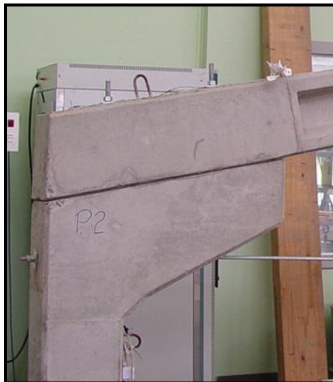
Figura 4.1 – Ligação Viga-Pilar com Chumbadores
