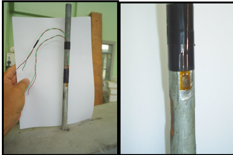
Figura 4.22 – Extensômetros colados no Chumbador
