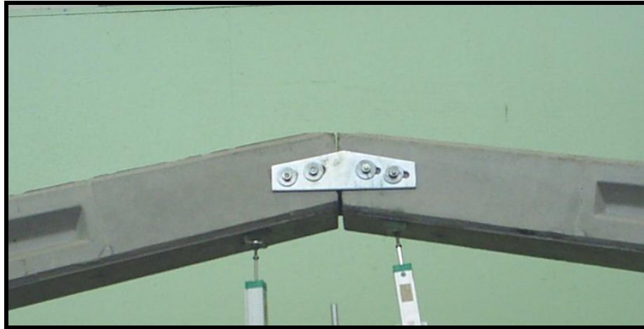
Figura 4.9 – Detalhe da ligação viga-viga
