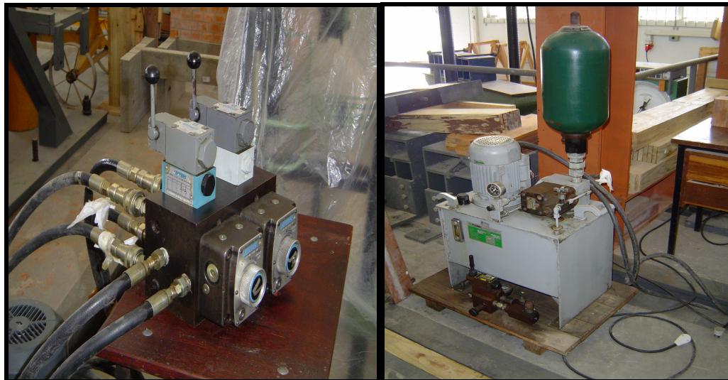
Figura 4.16 – Controladores de pressão dos cilindros hidráulicos
