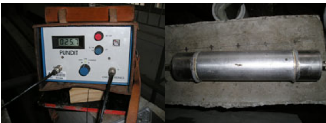
Figura 4.4 - Aparelho PUNDIT e barra de referência para calibração.
