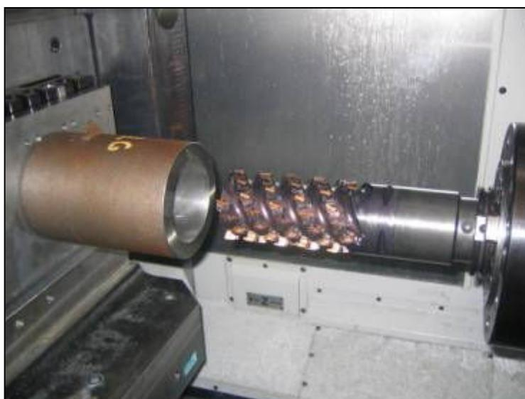
Figura 2.6 – Ferramenta de “freso-mandrillamento” (MAKINO, 2006).
