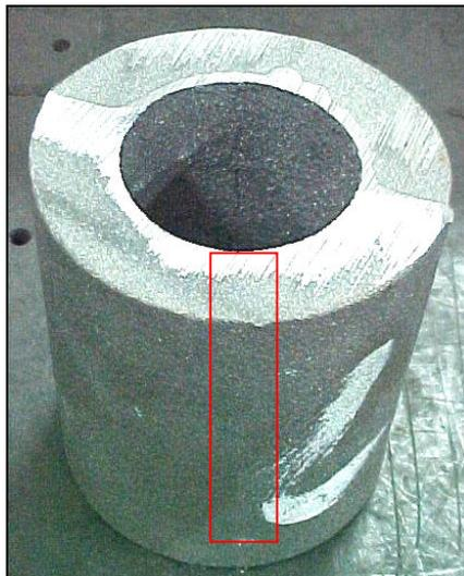
Figura 3.17 – Corpos-de-prova tipo camisas de cilindros fundidos empregados na Etapa 2 dos ensaios.
