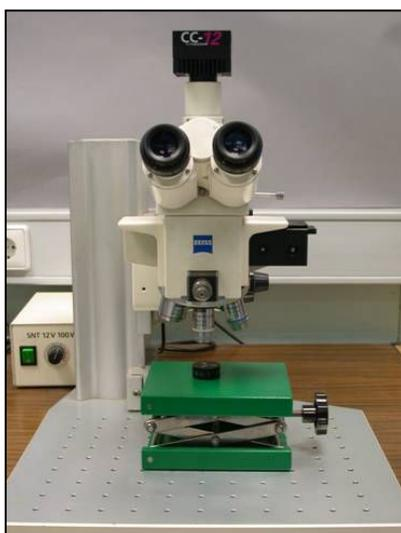
Figura 3.12 – Microscópio óptico empregado na análise dos segmentos abrasivos de brunimento.
