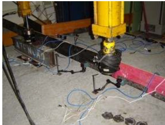
Figura 6.25 Fixação dos transdutores de deslocamento.
