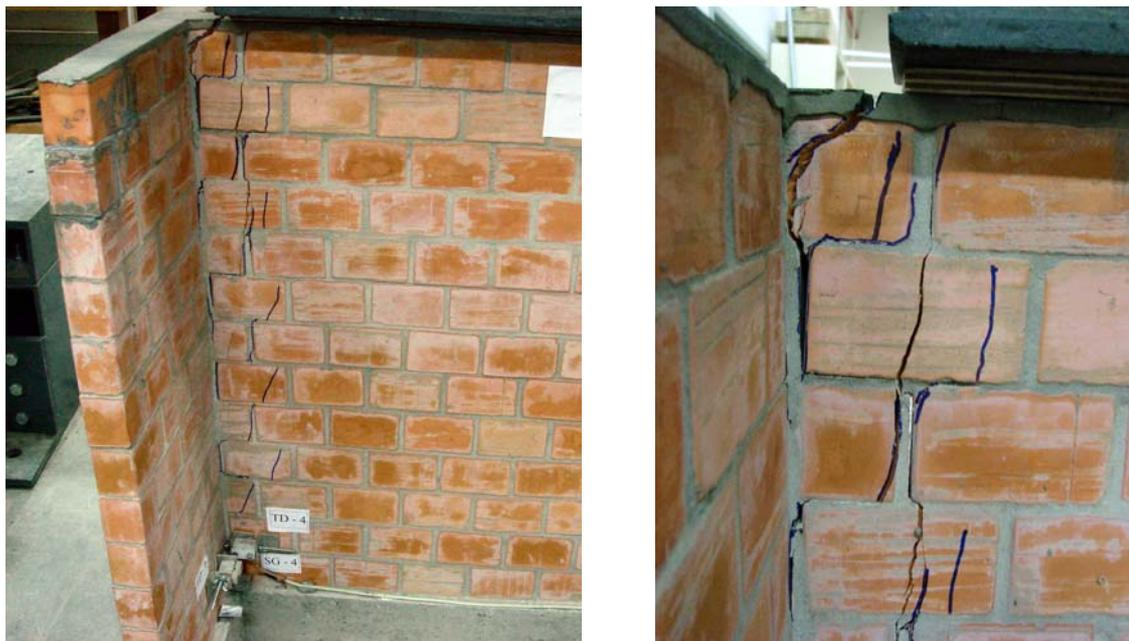
**Figura 5.41 – Protótipo 4. a) Fissuras na região parede/flange, b) detalhe da trinca na fiada do topo.**
