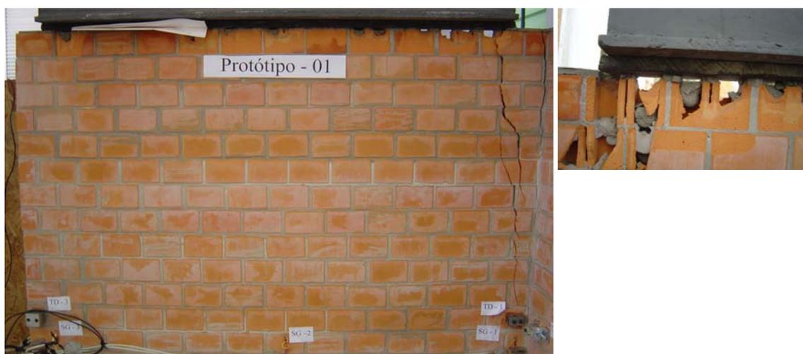
**Figura 5.33 – Aspecto geral da parede na ruptura e detalhes da ruptura próximo ao flange**
