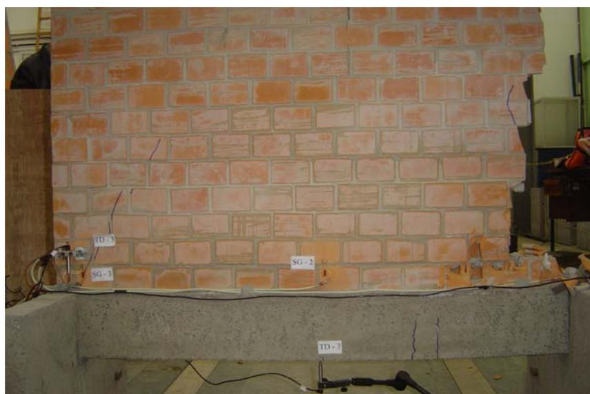
Figura 5.49 – Protótipo 2 - Vista frontal após a ruptura.
