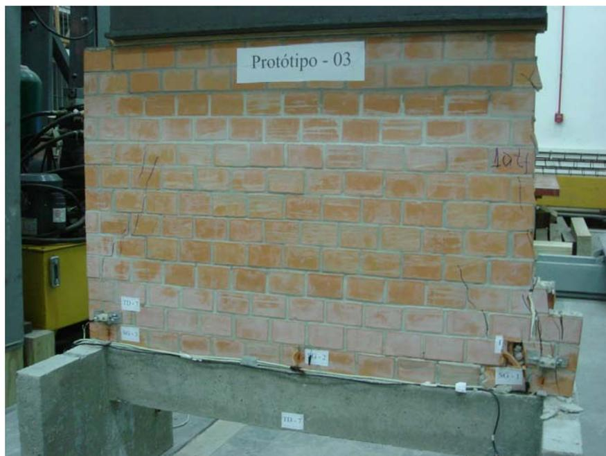
**Figura 5.57 – Protótipo 3 – após a ruptura**
