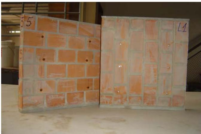
**Figura 5.9 – Paredinhas para obtenção dos módulos de elasticidade e coeficientes de Poisson nas direções normal e paralela às juntas.**
