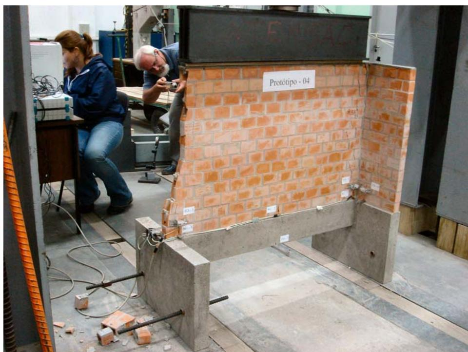
**Figura 5.42 – Protótipo 4 - Vista geral após a ruptura**
