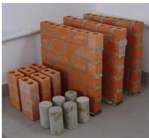
**Figura 5.2 – Parte do conjunto de corpos de prova de um experimento (protótipo).**
