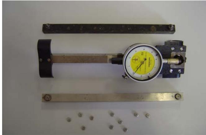
Figura 5.10 – “Demec gauge” – instrumento e gabaritos de fixação das pastilhas.
