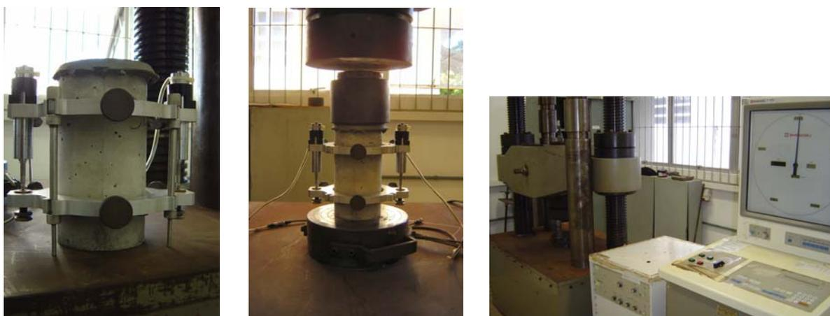
**Figura 5.5 - Aparato para a determinação das deformações longitudinais.**
