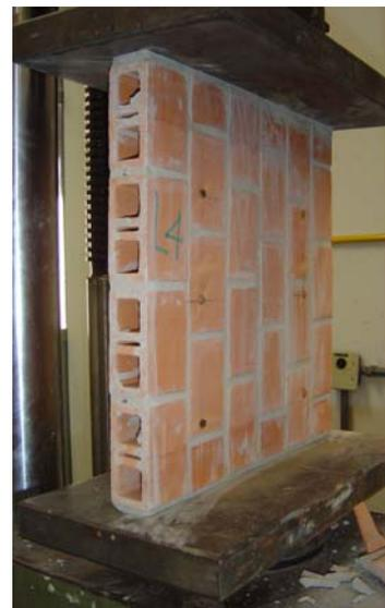
Figura 5.12 – Ensaio das paredinhas: a) normais b) laterais.
