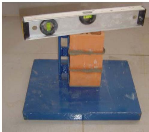
Figura 5.7 – Aparato para moldagem dos prismas.
