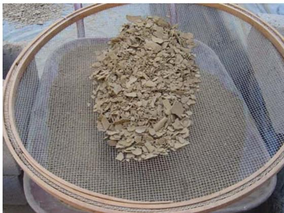
**Figura 4.3 Lâminas de argila retidas no peneiramento.**
