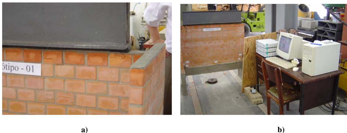
**Figura 5.29 – a) Uso do neoprene entre o capeamento e a viga metálica; (b) sistema de aquisição com o uso de três “Spiders”.**
