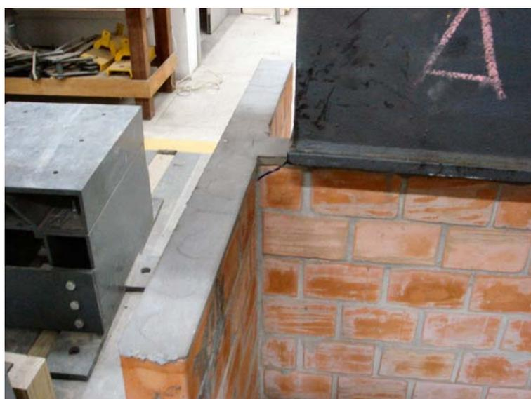
Figura 5.40 – Protótipo 4 – aparecimento da primeira fissura.
