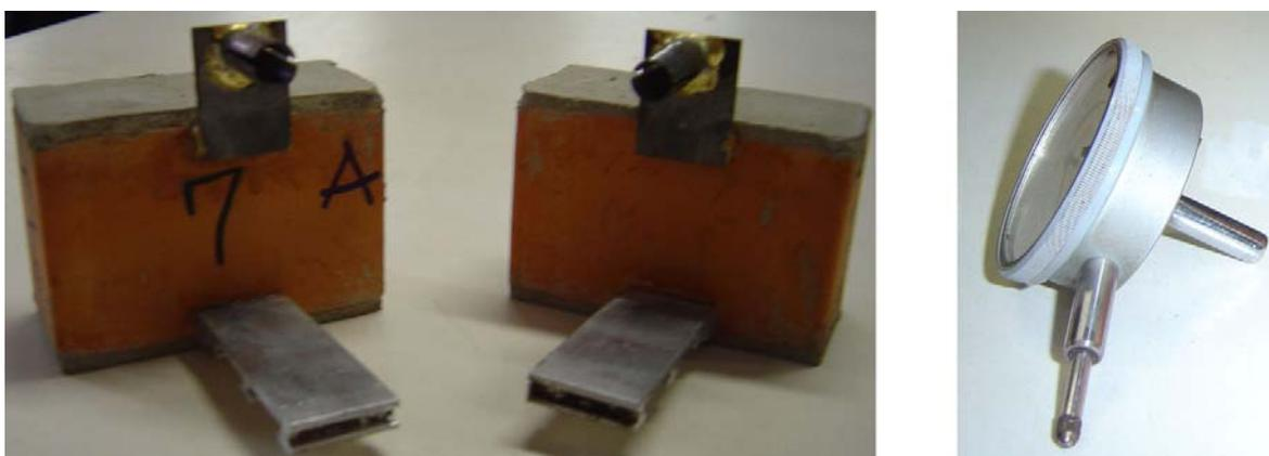
**Figura 4.9** Dispositivo para a fixação dos relógios comparadores.
