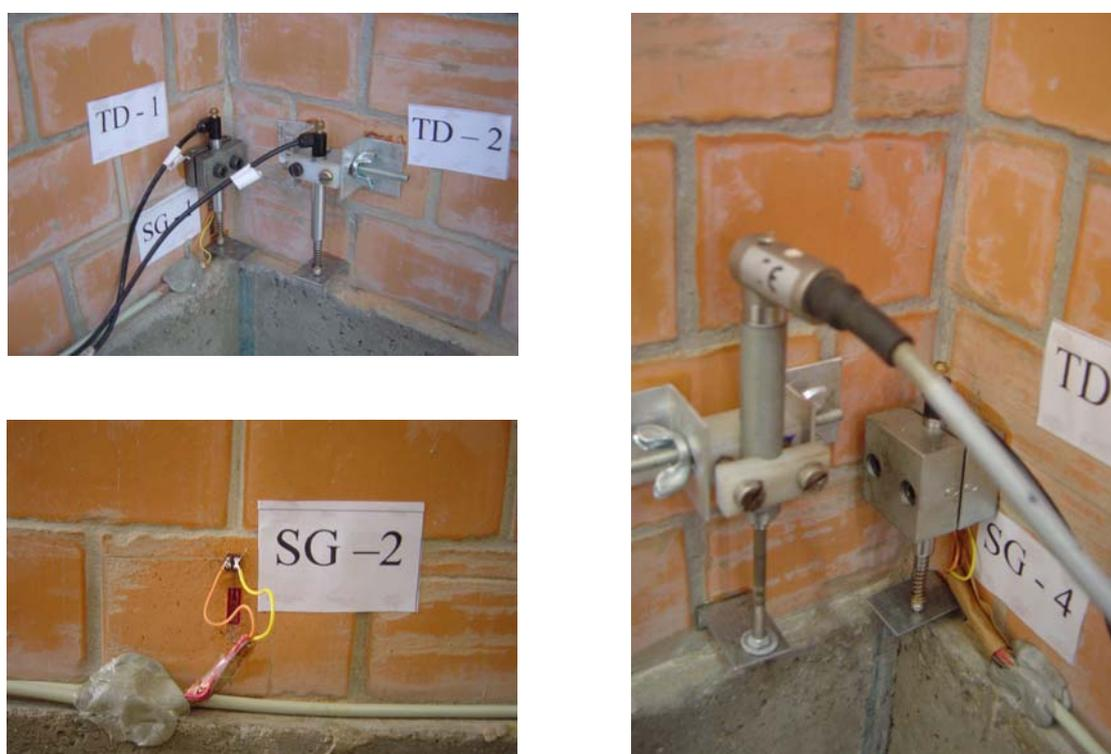
**Figura 5.30 –Detalhes dos “strain gauges” e transdutores.**
