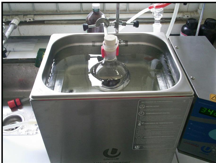
**Figura 17** Processo de mistura dos NTC e do ácido em aparelho de ultra-som.
