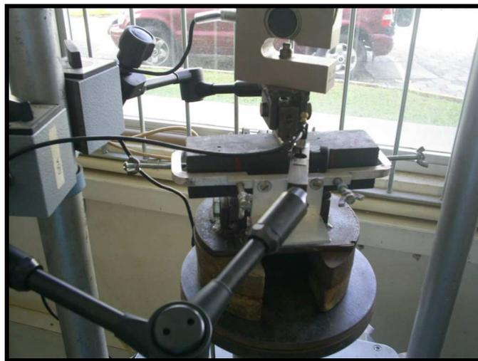
**Figura 19** Aparato para ensaio de resistência à flexão.
