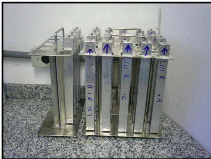
**Figura 22** Armazenagem dos corpos de prova após a selagem para medida de retração autógena.
