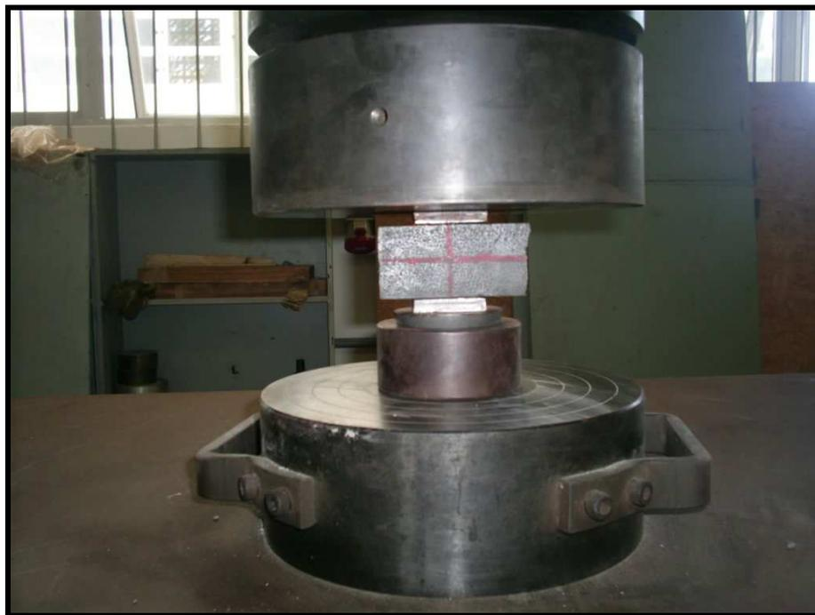
**Figura 21** Ensaio de compressão dos corpos de prova rompidos à flexão.
