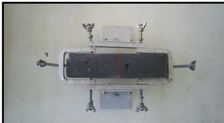
**Figura 20** Corpo de prova com o aparato para medir a deformação durante o ensaio.
