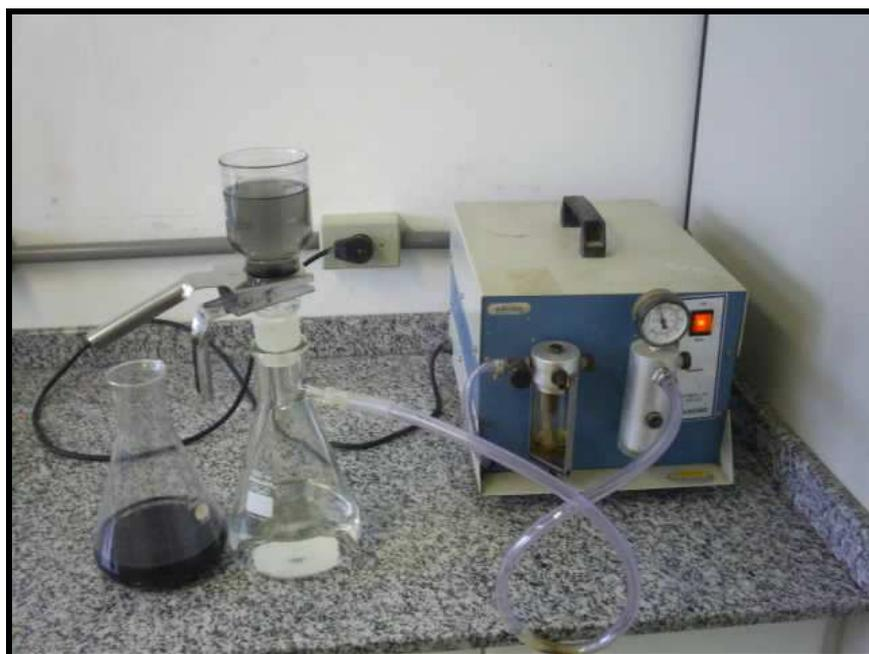
**Figura 18** Sistema de filtração utilizado após o tratamento químico.
