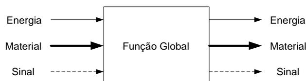
Figura 2-3 - Representação esquemática da Função Global, adaptado de Forcellini et al. (2005).
