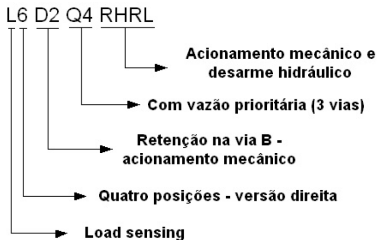
Diagrama 6.5 - Especificações técnicas da fatia com válvula compensadora de pressão de três vias (SCHWARZ, 2007).
