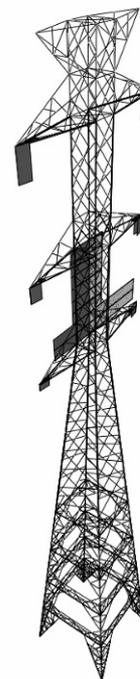
**Figura 72 – Momentos torçores, modelo 1 (esquerda) e modelo 2 (direita), caso 7.**
