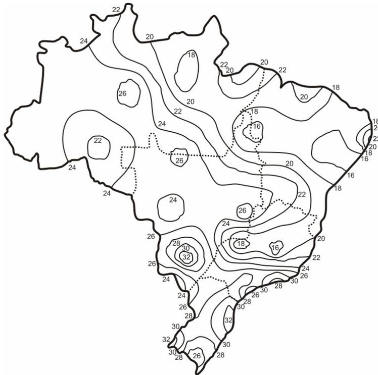
**Figura 15 – Isopletas do vento para velocidade básica.**
