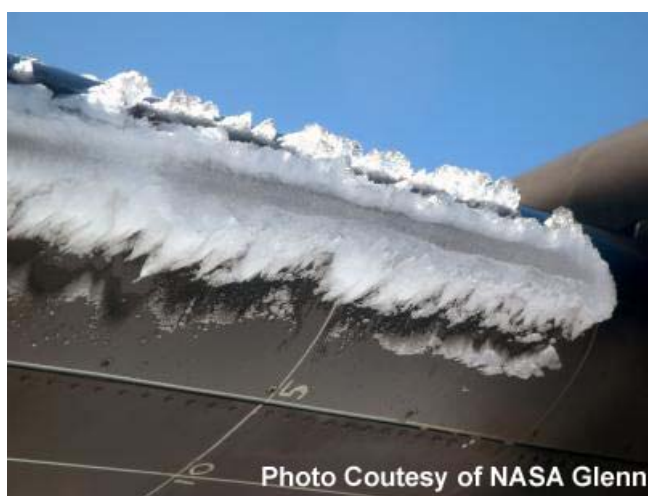
Figura 1.1 – Formação de gelo na borda de ataque de uma aeronave.
