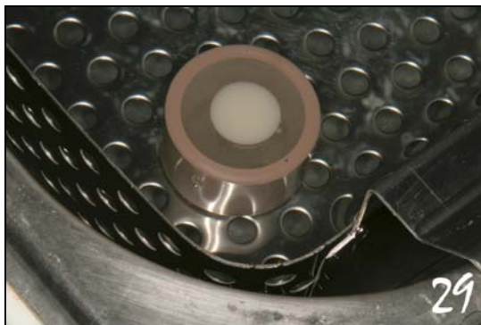
Figura 29. Banho ultrassônico em água destilada por 5 minutos.
