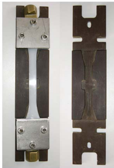
Figura 4.6: Gabarito utilizado para minimizar os efeitos de possíveis desalinhamentos na fixação das garras ao corpo de prova.
