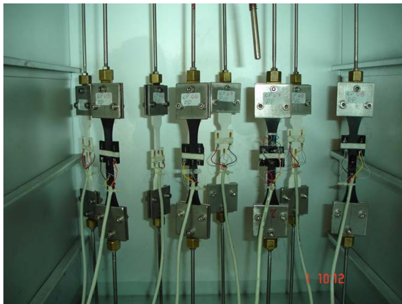
Figura 4.15: Ilustração da realização do ensaio de fluência em quatro corpos de prova de PVC (corpos de prova de cor branca) e quatro corpos de prova em polipropileno (corpos de prova de cor preta).
