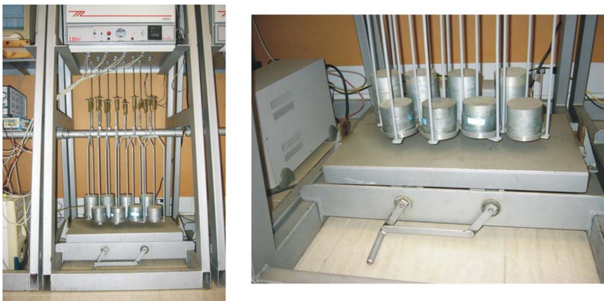
Figura 4.4: Ilustração da aplicação simultânea do carregamento a oito corpos de prova.
