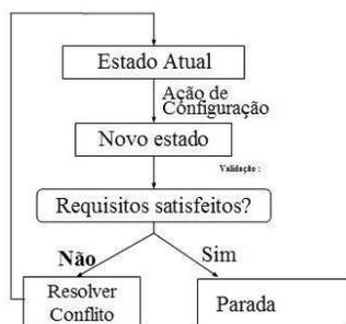
Figura 1: Fluxograma do algoritmo de configuração[Richter 2001]
