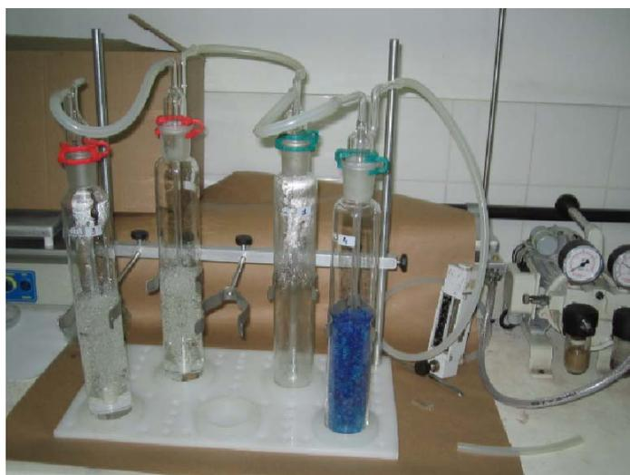
Figura 10: Aparato de amostragem para determinação da umidade dos gases.
