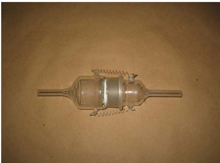
*Figura 11: Aparato de coleta de material particulado nos gases de exaustão.*
