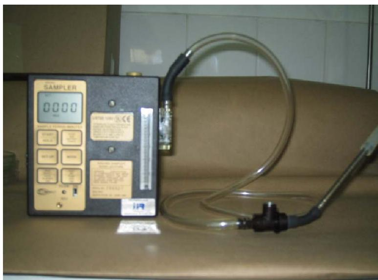
Figura 13: Bomba de amostragem e cartucho para coleta de COV.
