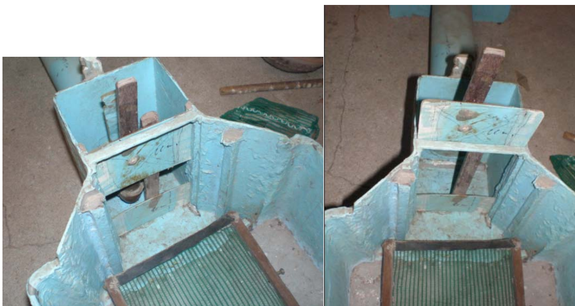
Figuras 6.11 e 6.12 – Modelo em maquete – detalhe da comporta em fibra (em duas partes que se deslocam numa ranhura).
