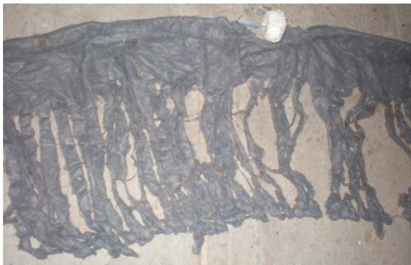
Figura 6.16 – Detalhe do “bidin”- duas cordas paralelas, bóias e feltro cortado
