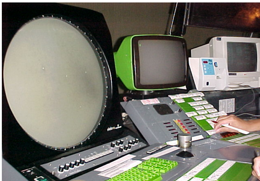
Figura 10: Visualização do console (tela do radar, monitores, impressora, teclado, mouse , strips , botões de sintonia para comunicação)
