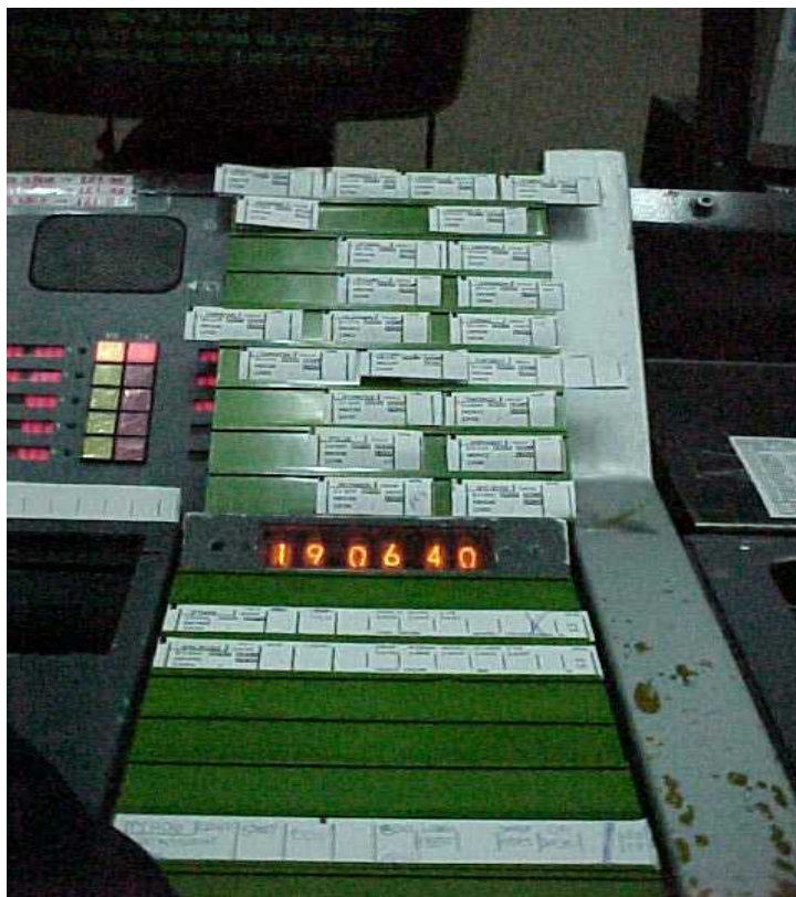
Figura 7: Disposição das strips pré-ativas (acima do relógio) e ativas (abaixo do relógio) no console
