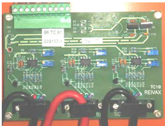
Fig. 5.5 – Placa dos transdutores de corrente.
